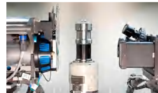
X 射线源 (左)、配带拉 / 压平台的样品台 (中)、探测器 (右)。即使射线源到样品之间的距离有几厘米来安放原位样品夹，体素也可以达到 1 微米以下。
