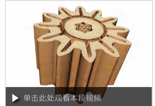
AM 铝齿轮的综合表征显示夹杂物、孔隙和相对于 CAD 模型 的尺寸偏差。样品由阿伦大学的 Timo Bernthaler 提供
