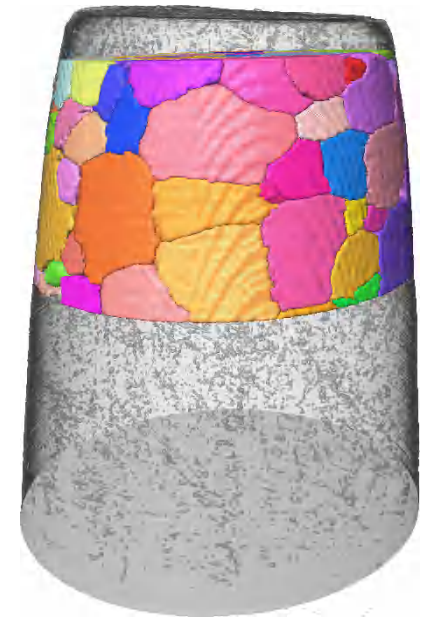
显示吸收和晶粒信息的 \text{Al}_4\text{Cu} 合金。由日本丰桥技术科学大学的 Masakazu Kobayashi 教授提供。
