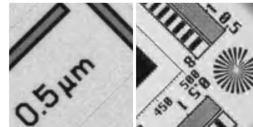
左：JIMA 分辨率标样上的真实空间分辨率为 0.5 μm 右：蔡司 Xradia 分辨率标样上的真实空间分辨率为 0.5 μm
