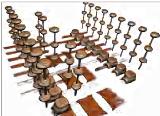
含 4- 晶片堆叠的 10 mm x 7 mm x 1 mm 封装内的 DRAM 封装互连。焊料挤压能轻松实现三维可视化，0.8 μm/ 体素。
