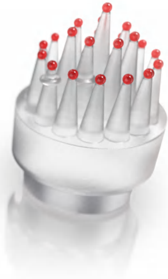
XRm 检查: 蔡司开发了一种 (多球面) 长度标准, 用于验证小尺寸 CT 测量的精度。根据 VDI/VDE 2630-1.3 指导准则, 用于确定偏差 SD。
