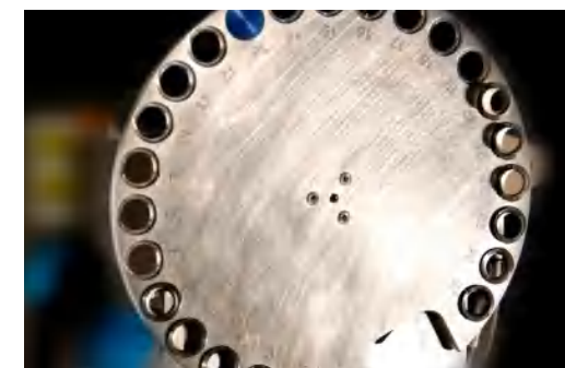
自动滤光片转换器 (AFC) 仅在蔡司 Xradia 620 Versa 上提供，包括 12 个标准滤光片和 12 个定制滤光片的孔位。
