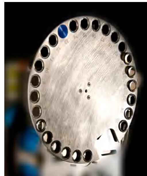
自动滤光片转换器包含有 12 个标准滤光片，同时也为定制滤光片预留有 12 个空位。
