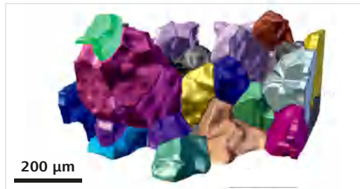
铝合金中晶粒取向的 LabDCT 3D 成像 (彩色 IPF (反极点图))。图片由丹麦科技大学提供。
