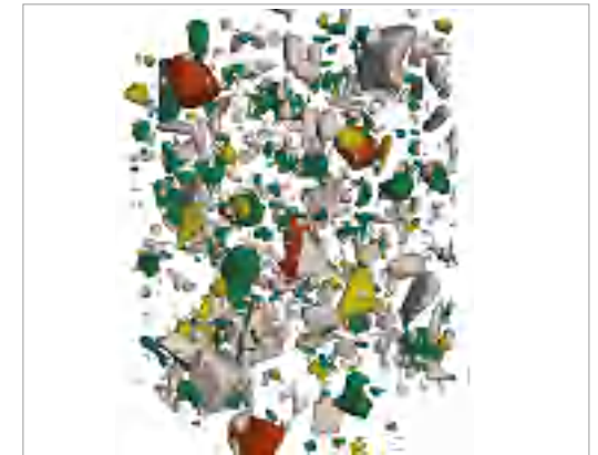
在 DSCoVer 中运用低能量和高能量数据对铝颗粒的三维分割结果进行可视化和分析。使用 2D 直方图，基于完整的 3D 数据来分割基材中的铝 (绿色) 和硅 (棕色)。(样品直径 3 mm)
