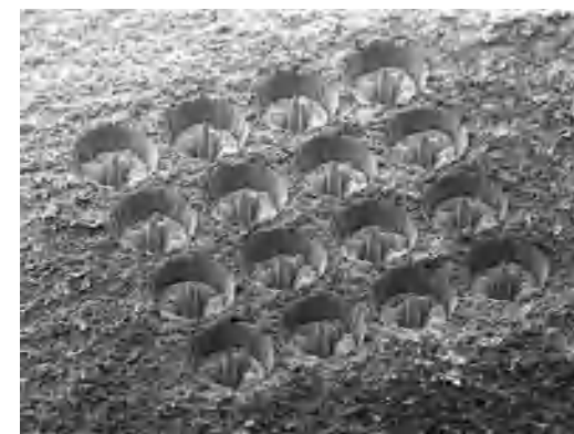
使用飞秒激光在钛合金中加工的 16 个微柱阵列，观察视野为 2.1 mm。Crossbeam 350 laser。
