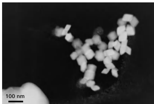
在 20 kV 暗场模式下，使用 aSTEM 探测器对 25 - 50 nm 氧化铁颗粒成像。
