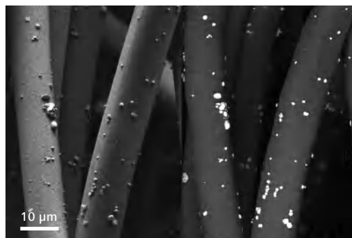
1 kV 下镀银纳米颗粒的纤维。左：InLens Duo 探测器的二次电子像；右：InLens Duo 探测器的背散射电子像。样品为伤口处理用的抗菌绷带。
