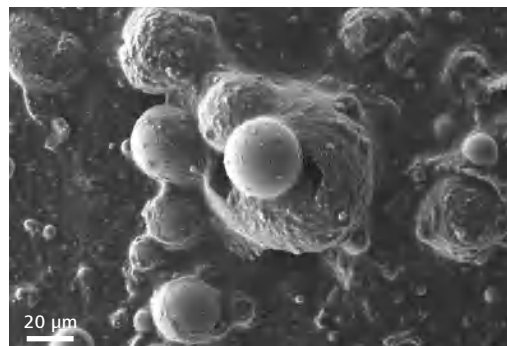
在 7 kV 和 25 Pa 气压下，使用 VPSE 探测器对气雾止汗剂氯化铝成像。
