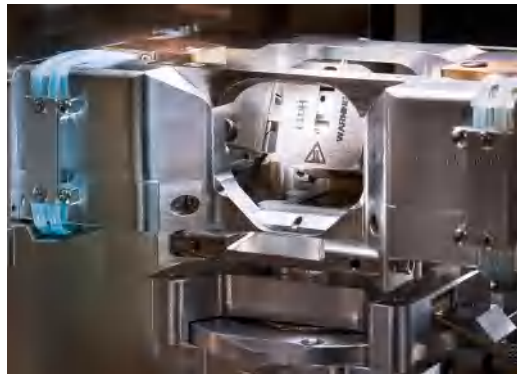
原位拉伸和加热台。样品倾斜至 70°，以进行 EBSD 分析。加热模块安装在样品下方，用于进行高温实验。
