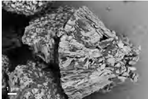
电池正极箔的颗粒表面。成分衬度用于识别 Li-NMC（镍锰钴锂电池）上的粘合剂（较深的材料），使用 aBSD 成像。
