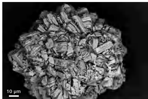
在 1 kV 下，使用 InLens Duo 探测器 BSE 模式下对碳酸镧成像。 LaCO 3 作为一种磷酸盐粘合剂，可用作透析患者口服治疗药剂。
