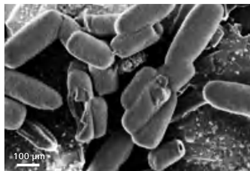
用于给药的 MSC 胶囊（空心介孔二氧化硅）。使用 InLens SE 探测器在 500 V 下成像。样品由德国科隆大学无机化学研究所的 V. Brune 和 S. Mathur 提供。
