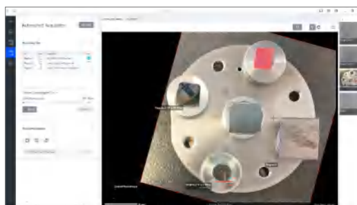
在 ZEN Connect 的工作界面内为 SEM 拼图创建采集区域, 并自动采集。
