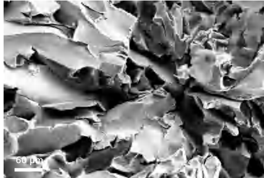
断裂表面——钢样品发生拉伸脆性失效。样品由英国剑桥实验室提供。
