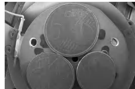
概览模式提供了一个超大观察视野，可以轻松导航和快速重新定位 ROI。使用 SE2 探测器在 5 kV 下进行成像。
