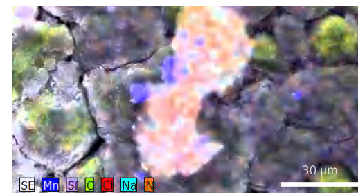
7 高级 EDS 探测器 拥有 8.5 mm 工作距离和 35° 出射角的高级 EDS 分析型几何探测器，可以以两倍速度或一半束流的条件获取数据（样品由英国莱彻斯特大学提供）。
