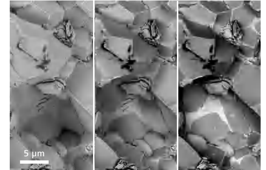
钕铁硼 (NdFeB) 磁体 (经消磁处理) 的断裂表面, 如 NEV 电机中使用的磁体。样品在 3 kV 和 7 mm 工作距离下成像。三种不同的衬度分别由 aBSD 探测器的外环、中环、内环获得。
