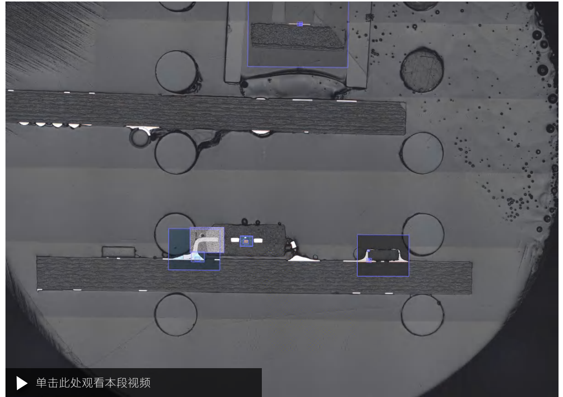
电子部件的多模态检测, 关联光学显微镜、SEM 图像和 EDS 成像中的分析数据。ZEN Connect 关联工作界面的 GUI 视图, 数据已校准。样品为电子部件, 镶嵌并机械抛光横截面。样品由德国阿伦大学材料研究所提供。
