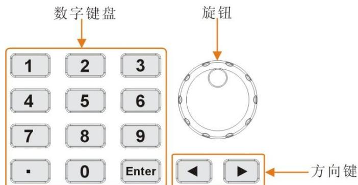
(1) **直接数据输入**：该输入方式采用数字键盘、左方向键和确认键来完成，适用于下述几种参数设置。
