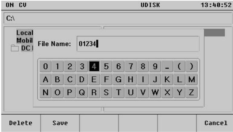
旋转旋钮或者按下旋钮，输入 01234 对文件进行命名，保存的定时输出数据的文件名为 01234，按 **Save** 进行保存。按 **OK** 确认保存，按 **Display** 此时举例中的定时输出数据保存完毕并回到开机显示界面。
