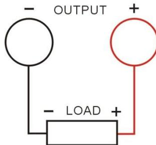
参考下表选取输出引线，并尽量使用较短的引线。
