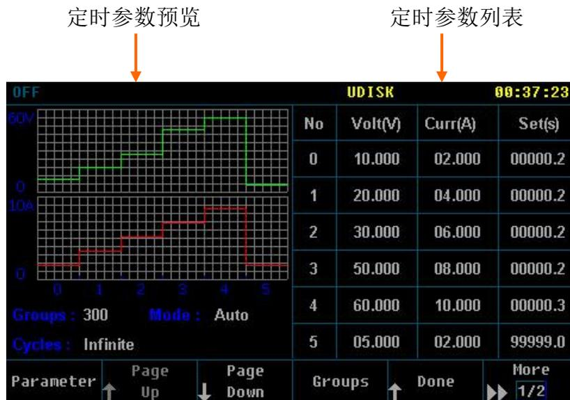
重复按下旋钮，编辑对象在组数->电压->电流->输出时间(No V A S)切换，用数字键和旋钮输入举例中的三组数据。当编辑对象在组数(No)时，旋转旋钮，进行组数选择。最多可编辑300组。
