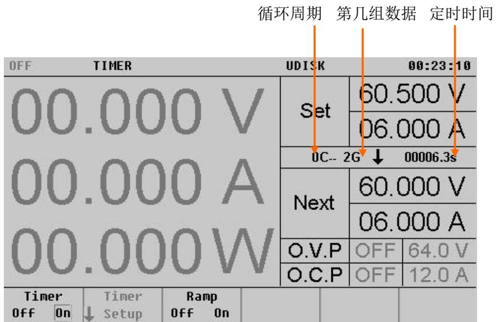
如下图所示, 波形显示模式下, 定时输出情况可以通过波形显示出来。
