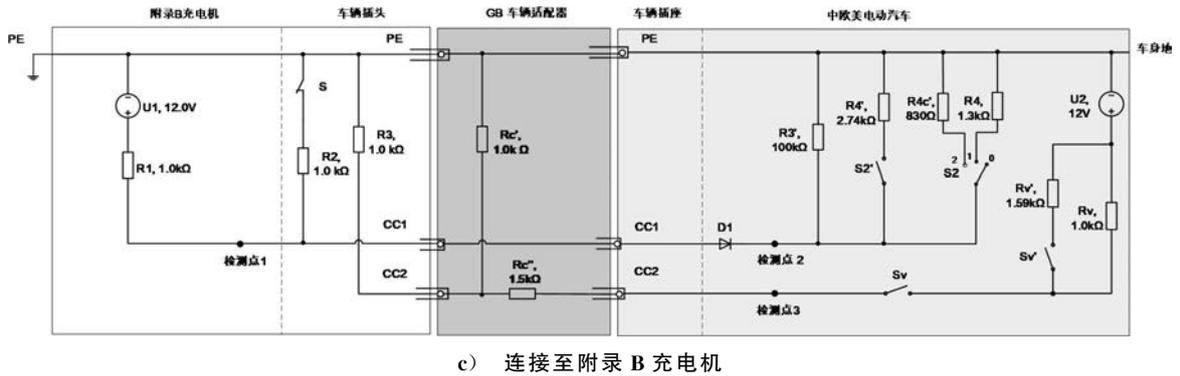
图 H.2 中欧美直流充电控制导引充电兼容解决方案 (续)
