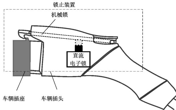
图 I.3 直流车辆接口(GB/T 20234.3—2023)锁止装置示意图
