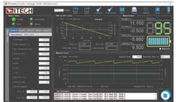
BSS2000电池模拟软件测试界面
