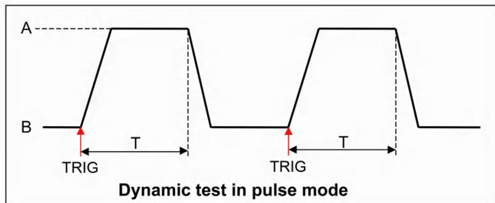
以CC模式为例（其他模式操作类似），当被测仪器输出电压为10V，电流3A，负载电流在1A和2A之间切换，设定动态测试参数和执行动态测试的步骤如下。
