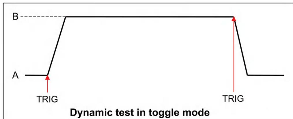
以CC模式为例（其他模式操作类似），当被测仪器输出电压为10V，电流3A，负载电流在1A和2A之间切换，设置动态测试参数和执行动态测试步骤如下。
