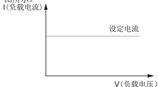
在定电流模式下，电子负载提供三种方法设置定电流值。
