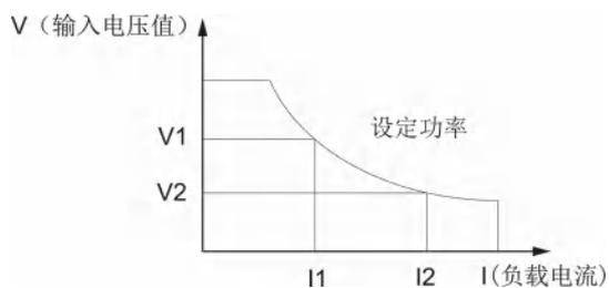
在定功率模式下，电子负载提供三种方法修改定功率值。
