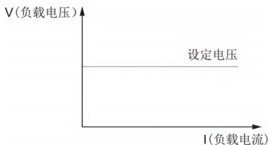
在定电压模式下，电子负载提供三种方法修改定电压值。
