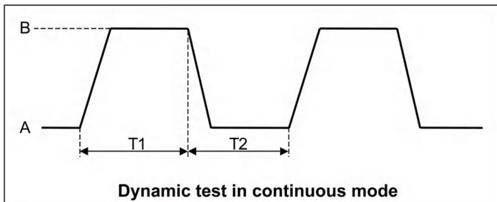
以CC模式为例（其他模式操作类似），当被测仪器输出电压为10V，电流3A，负载电流在1A和2A之间切换，设定动态测试参数和执行动态测试步骤如下。
