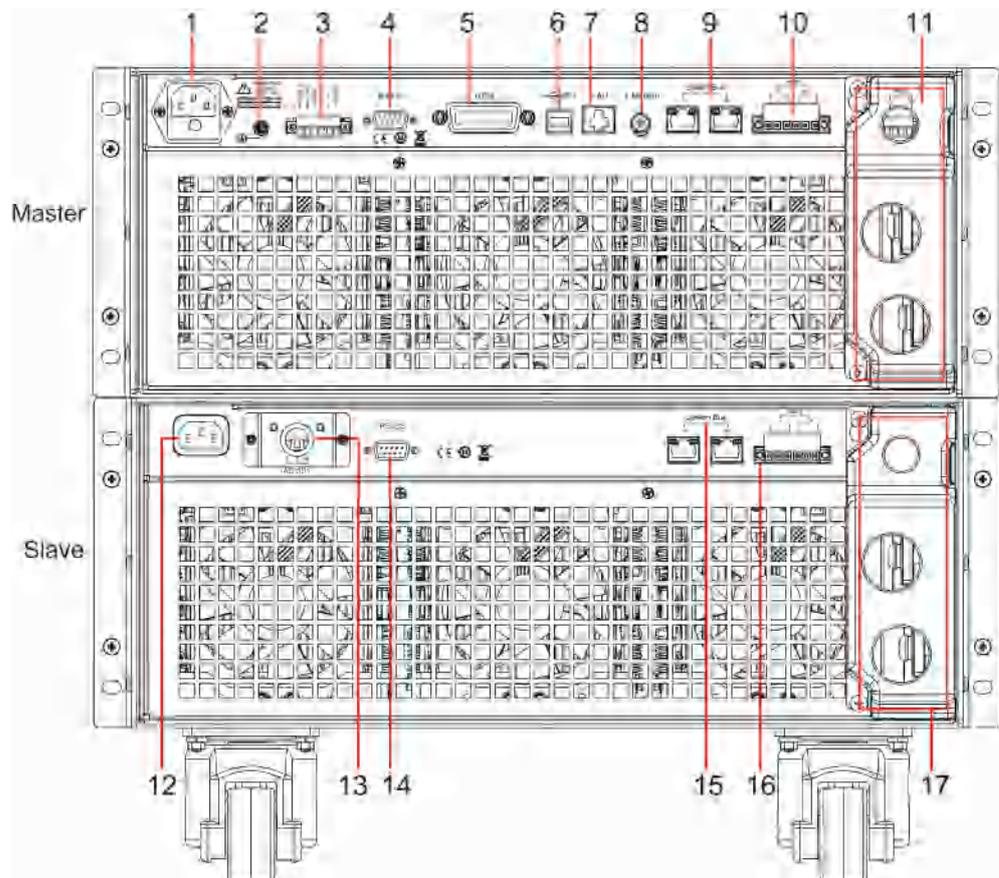
1. 主机电源输入插座，已连接至从机AC OUT 端子
