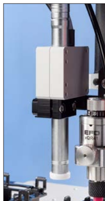
笔形摄像头可对产品的实际定位进行确认。
