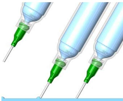
**谨记** — 在针头和工作表面接触时应保持如图所示的角度。当针头被放置在正确位置时，踩压脚踏板。释放脚踏板时，应垂直向上的移开针头。
