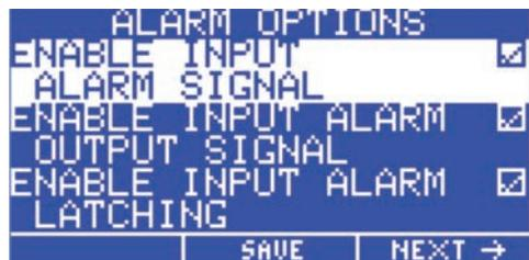
如需清除“输入报警”, 可浏览主屏并使用 Up/Down (8/2) 键和 Left/Right (4/6) 键选择“输入报警”。按 F2 (重置) 键, 清除输入报警。“启用输入报警锁定”旁边方框内的复选标记, 表示“报警输入锁定”已被启用。
