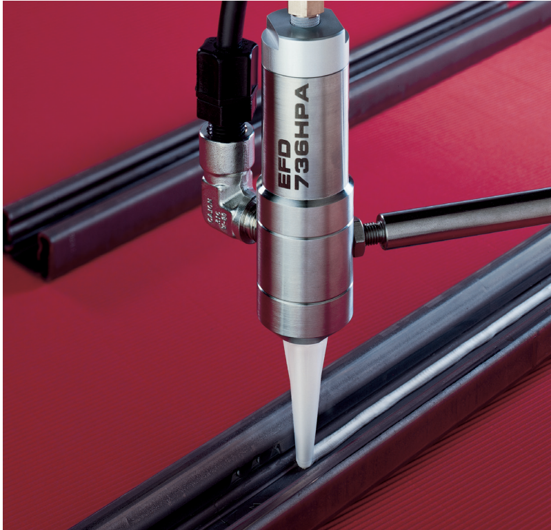
在汽车阀盖壳体部件涂覆硅胶。
