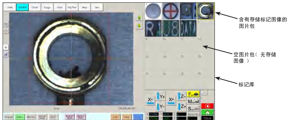
显示在主视图屏幕上的摄像头屏幕，以及显示在辅助视图屏幕上的标记库
