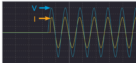
Stand-By待机投入功能实现快速的待载启动测试
