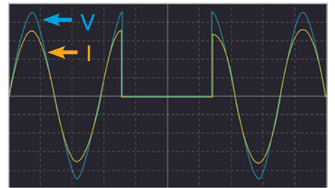
以CR Mode进行电压中断拉载测试
