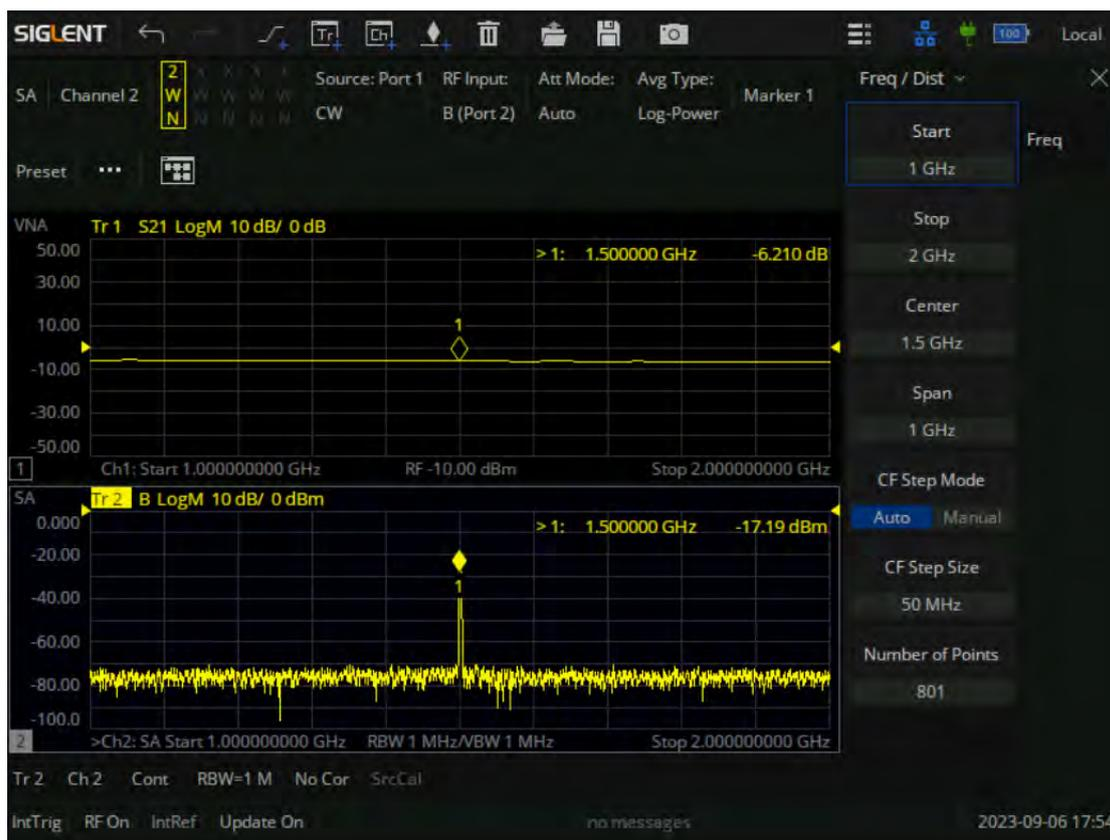
图 9-3 通过按【Freq】键进行 SA 频率相关参数设置
