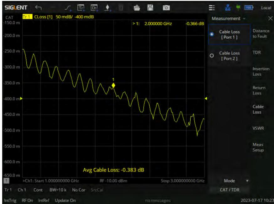
图 11-8 线缆损耗测量界面
