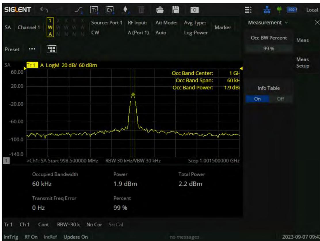
图 9-14 Occupied BW 测量界面
