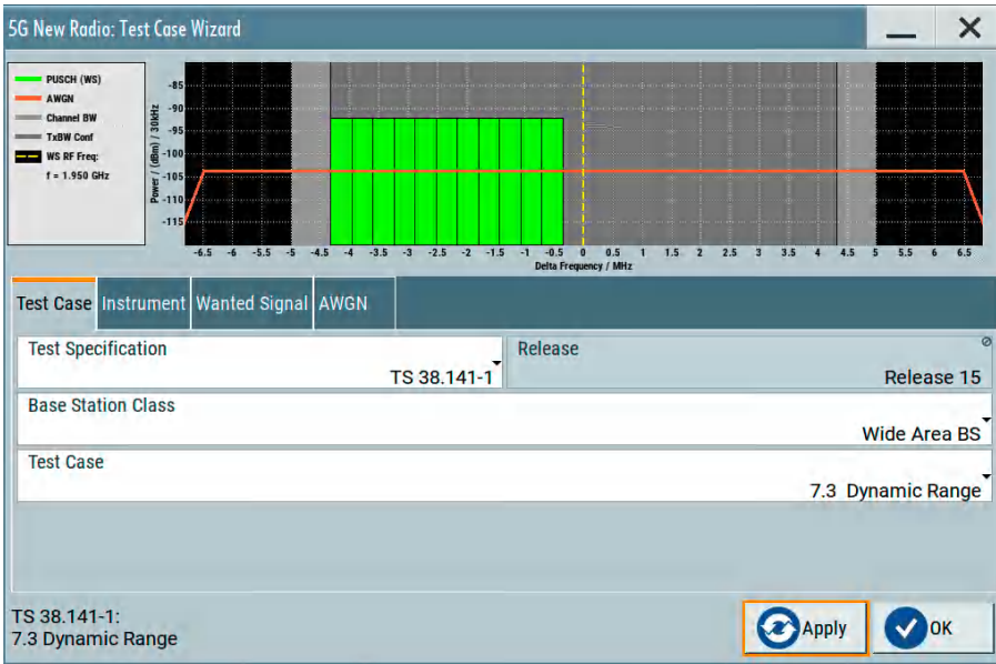
5G NR测试用例向导能够便捷灵巧地配置R&S®SMM100A，以根据3GPP TS 38.141进行基站收发机测试
