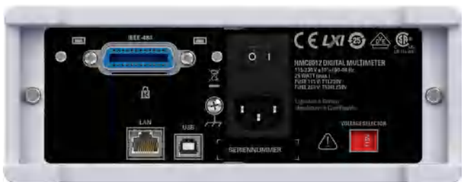
Abb. 1.2: Rückseite HMC mit Netzspannungswahlschalter und Anschlüssen
