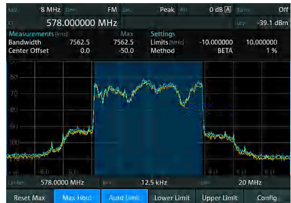
DVB-T信号的自动占用带宽测量(β %方法)。
