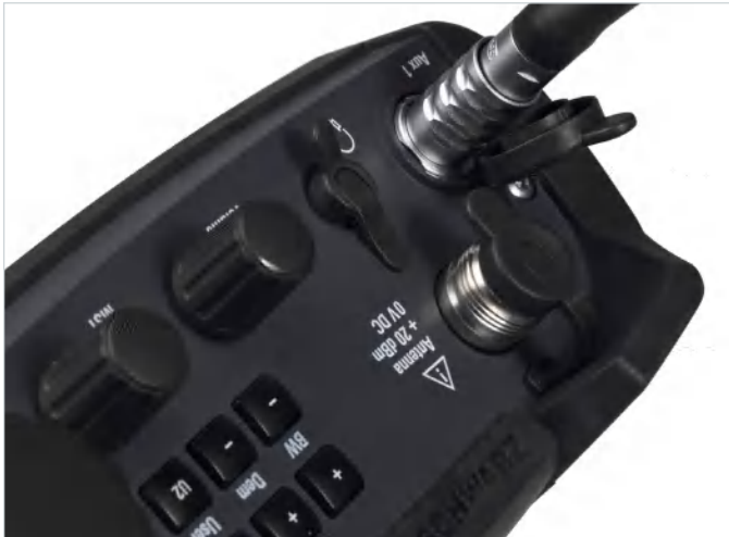
快速连接和断开罗德与施瓦茨天线。
