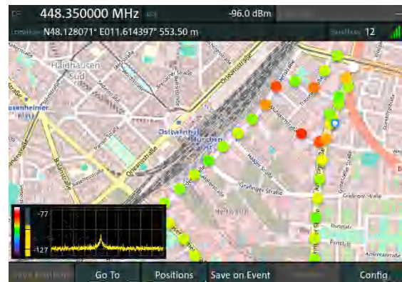
通过电平测绘进行的覆盖测量和集成式频谱视图。
