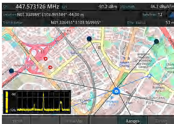
根据不同位置记录的多个测向结果进行三角交汇定位。
