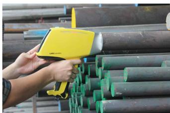
配置的Super-FP算法无需切换模式即可准确分析出金属元素含量及材质！
