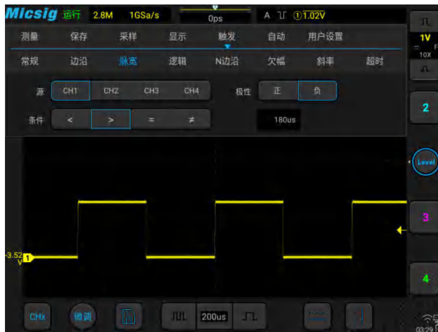
图6-15 负极性脉冲电平翻转
