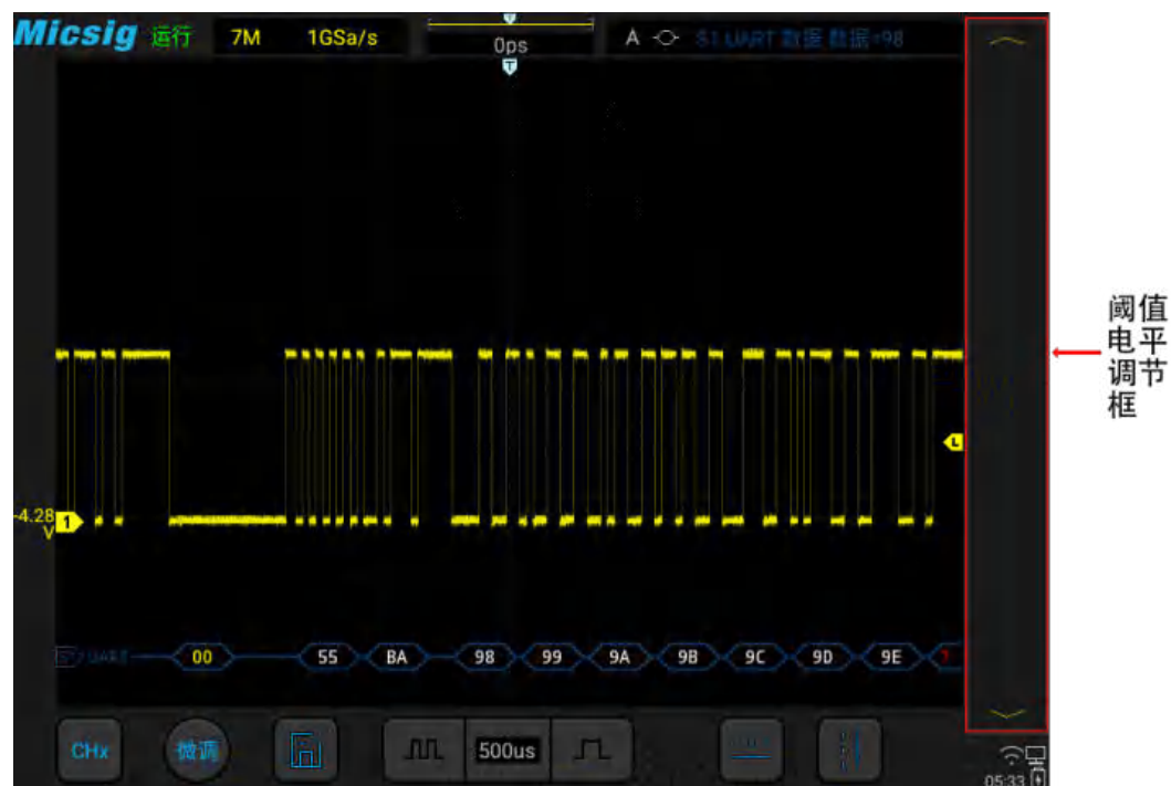
图12-7 UART 解码电平调节
