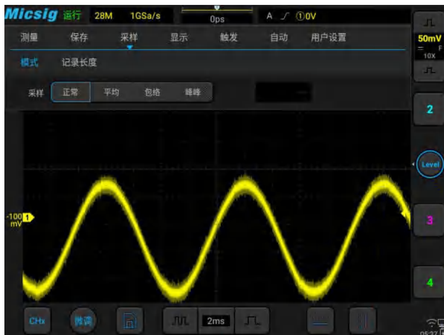
图11-5 带毛刺的正弦波，正常采样模式
