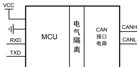
图 1 CSM100 系列模块的功能框图
