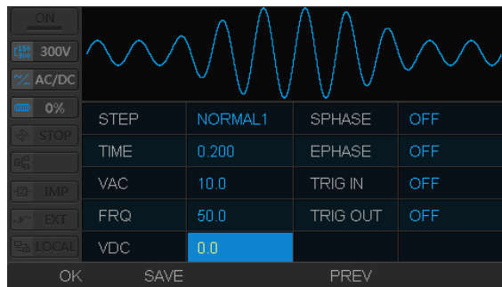
图 5.33 正常供电状态 1 设置界面
