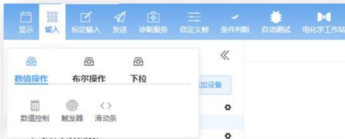
添加完组件后，在左侧的 DBC 中选择需要的 Signal 信息，拖拽到对应的组件中即可进行数据的观测。
