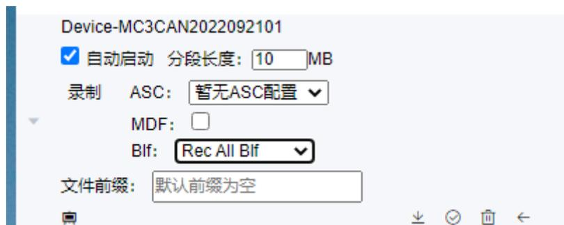
在设备名后的配置按钮中勾选自动启动按钮，分段长度代表文件大小，用户可根据项目需求进行配置文件大小。选择文件类型“Rec All Blf”，点击下方的“√”按钮进行保存，并点击下方配置。
