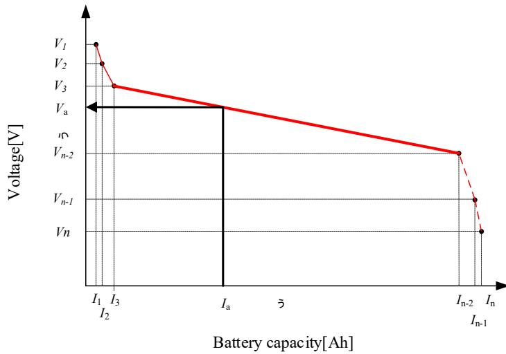
图1 线性插补模式（放电时的操作）
