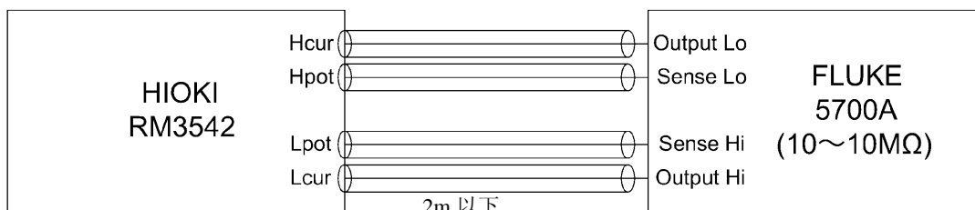
用 FLUKE5700 校正为 10Ω ~ 10MΩ
