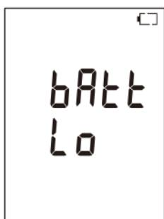
在没有电池余量的状态 (
