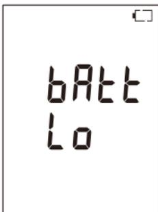
在没有电池余量的状态 (
