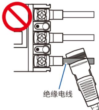
用线夹根部夹住绝缘电线
