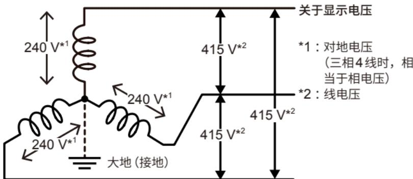
在图中所示的400 V线路中，线电压为415 V，而对地电压约为240 V。可使用对地电压为300 V的测量仪器。
