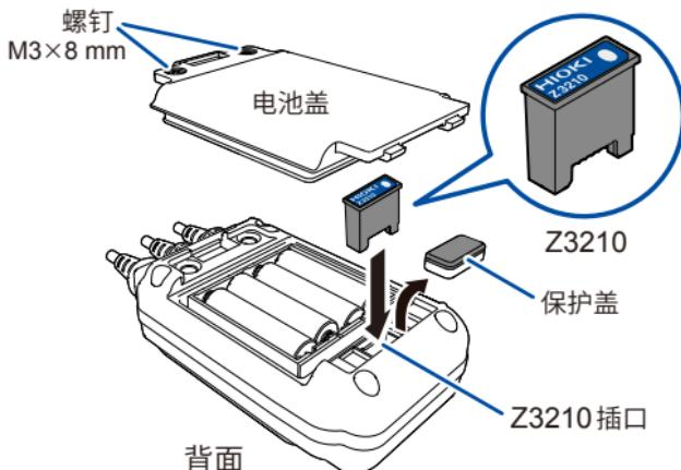
为了保持防尘、防水性能，不论有无Z3210 无线适配器，都请在Z3210 插口上安装保护盖。
