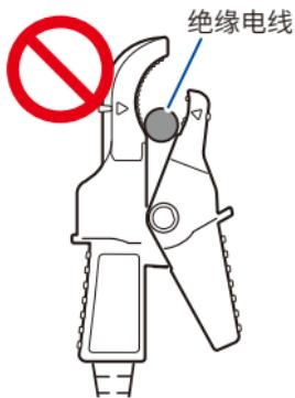
同时夹住电压不同的绝缘电线
