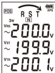
除了三相电路之外，本仪器还可测量电压传感器之间的线电压。
