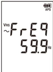
2 确认测量值 (显示线电压  $V_{RS}$  的频率)
