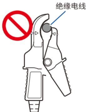
倾斜地夹住绝缘电线
