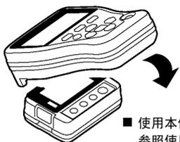
对准 Data Logger 的红外线端口与本仪器的红外线端口进行安装。
