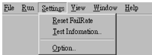
**[Settings]→[Reset FailRate]** 將 Fail Rate 的計算值歸零，重新開始計算 Fail Rate。
