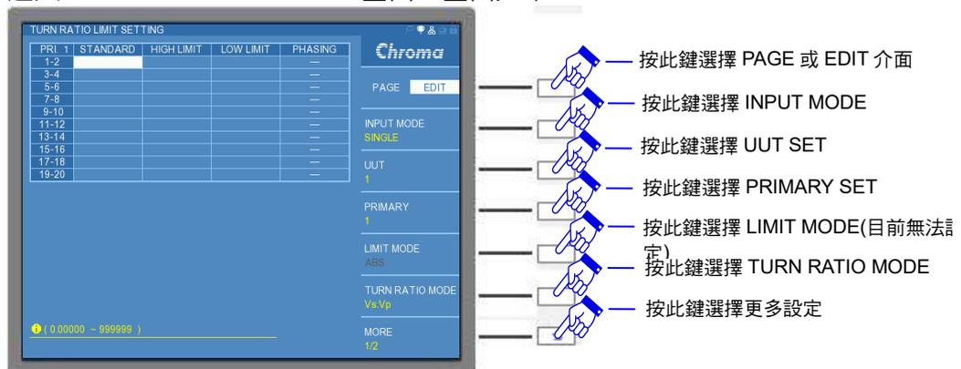
TR FAIL LOCK：變壓器掃描測試失敗進而汽缸鎖住功能。當此功能開啟(ON)後，進入 TRANSFORMER SCAN TEST 畫面進行測試時，若測試結果為失敗狀態 (FAIL)，汽缸將會自動鎖住依然壓合待測物，不會自動回復，使用者需按下 RESET 鍵，才能將汽缸狀態回復，繼續下一個待測物之測試。出廠預設值為 OFF(關閉)。
