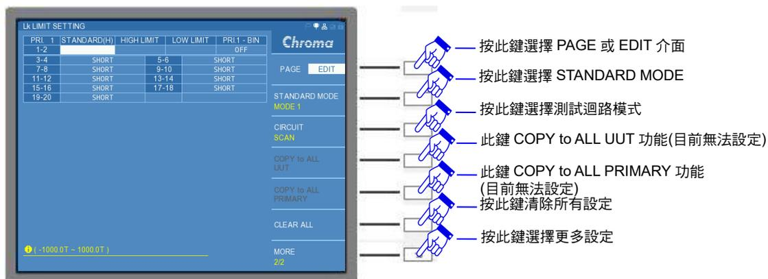
STANDARD MODE 可設定 MODE 1 與 MODE 2。MODE 1 為使用者自行設定 STANDARD 測試值，而 MODE 2 則為使用者不設定 STANDARD 測試值時，本測試機將以設定線圈所量測到的電感值 (Lx) 當作 STANDARD 測試值。
