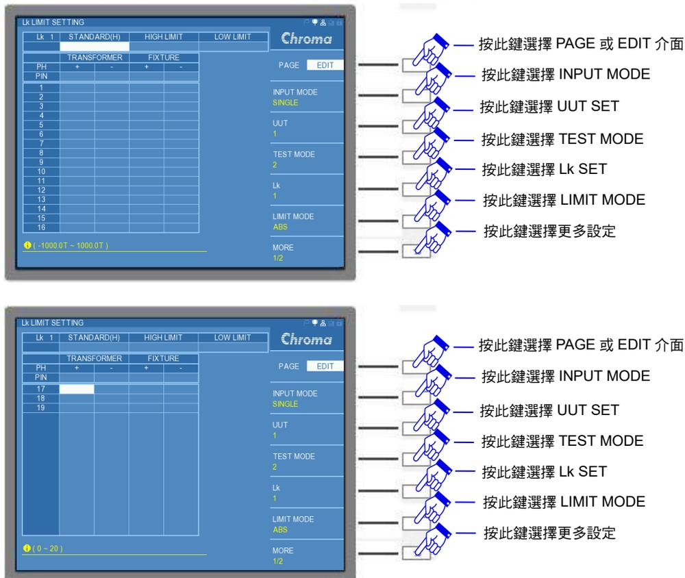
在 TEST MODE 2 狀態下，可自由設定欲量測某繞組之漏電感量，其餘欲短路設定之繞組亦可自由設定。在最上方的欄位為輸入 STANDARD(待測物漏電感量標準值)、HIGH LIMIT(待測物漏電感量上限值)以及 LOW LIMIT(待測物漏電感量下限值)等數值，接下來的欄位為變壓器 (TRANSFORMER)與測試治具 (FIXTURE)之腳位設定，PIN 欄位為設定欲量測漏電感量之繞組腳位，下方編號 1~19 之欄位為可設定短路之繞組腳位。若搭配之測試治具為 A133502 20CH 掃描測試單元(選購)，最多可設定 19 組繞組腳位短路；若搭配 A133505 掃描測試盒(選購)，最多可設定 79 組繞組腳位短路。欲設定不同組合量測 Lk 參數，可在 EDIT 介面內選擇
