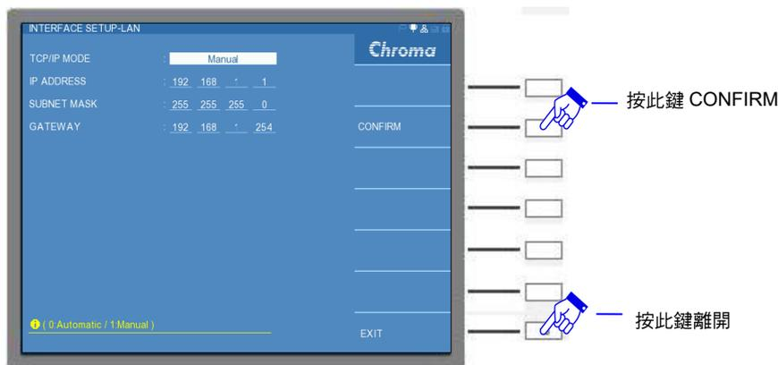
TCP/IP MODE: Transmission Control Protocol 與 Internet Protocol 通訊協定設定方式。本測試機共有自動 (Automatic)與手動 (Manual)等兩種選擇。若選擇自動模式，此時網域上須架設一 DHCP (Dynamic Host Configuration Protocol)伺服器，本測試機會自動向 DHCP 伺服器取得 IP ADDRESS 與 SUBNET MASK 及 GATEWAY 設定，取得設定後請按下 CONFIRM 選項，本測試機將確認此設定；若選擇手動模式，需自行設定 IP ADDRESS 與 SUBNET MASK 設定，設定完成後請按下 CONFIRM 選項，本測試機將確認此設定。出廠預設值為 Manual。
