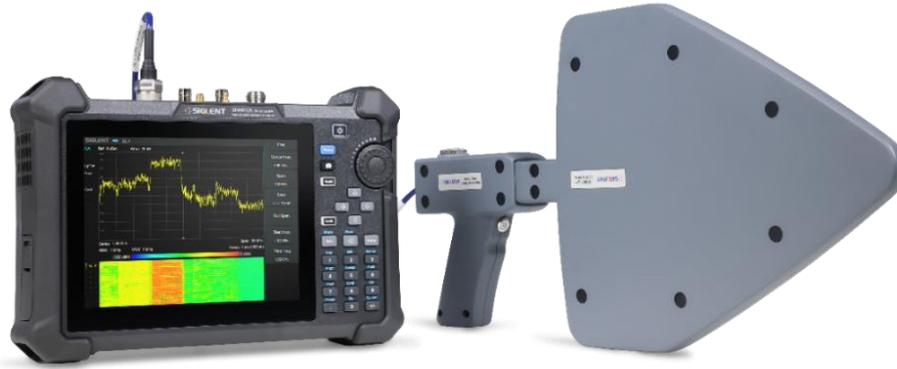
基于时域测量的电缆和天线故障点定位
