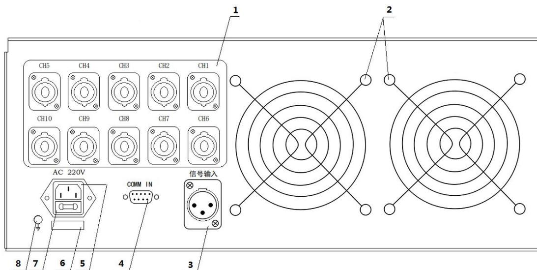
图 2.4 功放机后面板示意图
