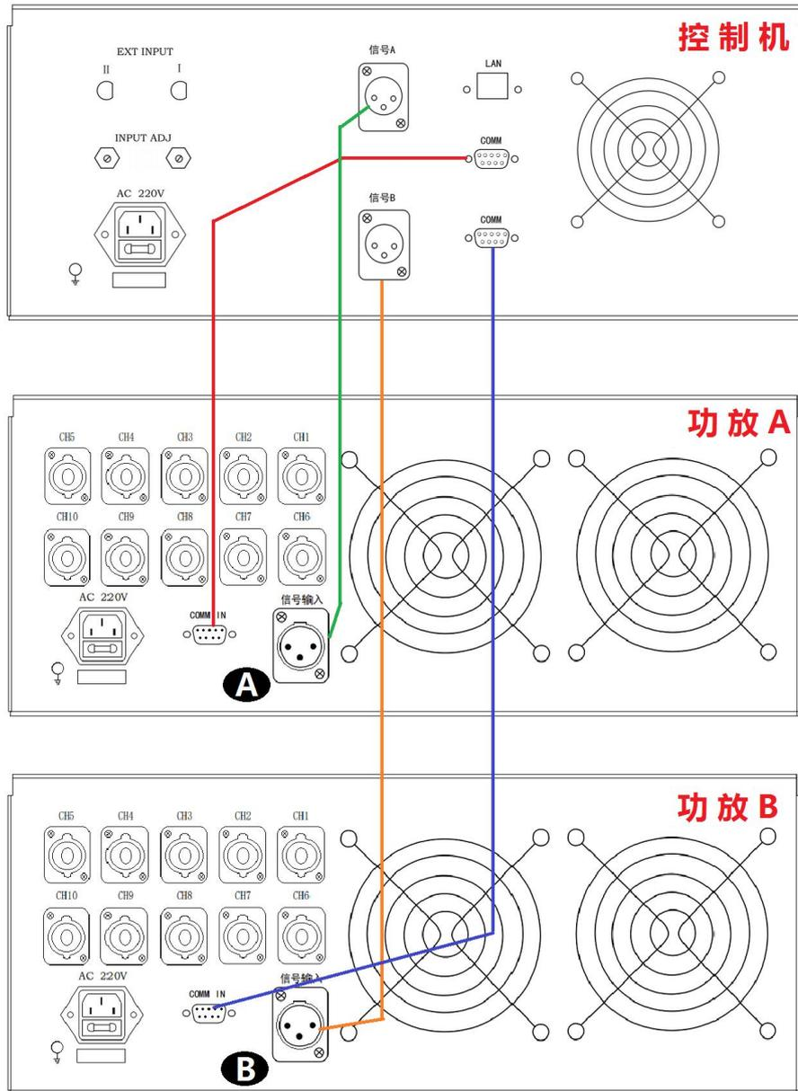
**连线说明：** 工控机的信号 A → 功放 A 的信号输入；
