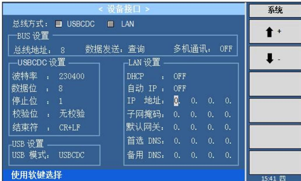
图 4.4.5 设备接口-IP 地址界面
