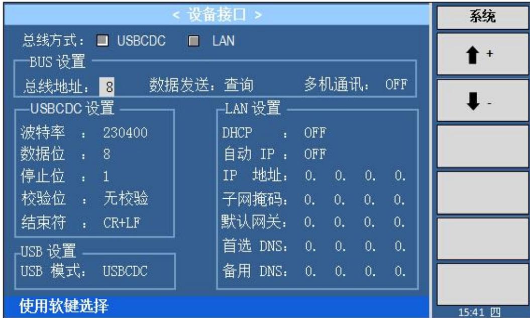
图 4.4.2 设备接口-总线地址界面
