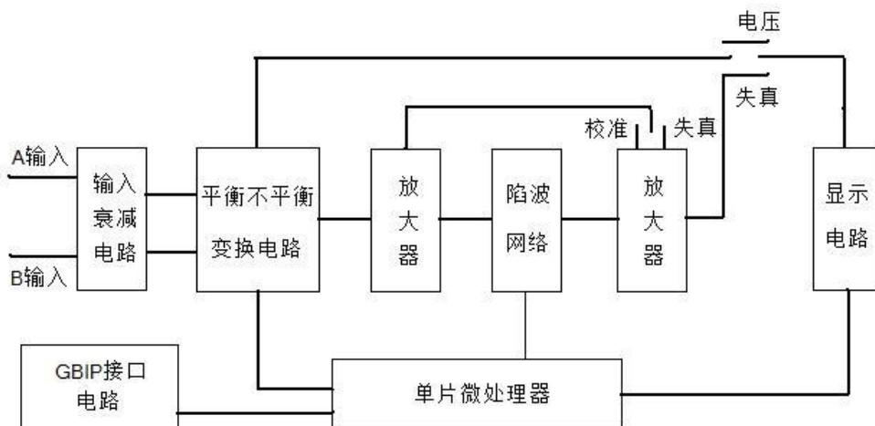
设计中对关键电路和器件采用了特殊的设计和制造工艺，并采用了当代计算机技术与之相结合，程控自动跟踪输入信号的频率、幅度，自动滤谐，全部数据由一块 LCD 显示屏集中显示。仪器面板上保留了示波器输出监视插孔，便于使用者直接观察被测信号的波形，特别在失真测量状态，使用者可直接观察到被测信号的失真主要是由哪次谐波形成的及滤谐状态，在小失真信号测量时，可以直接观察到整机的滤谐状态。对平衡信号的测量，本仪器设计时放弃了老式仪器采用平衡变压器转换的方案，因为它制造工艺复杂，造价高，使用频带窄。本仪器设计了特种平衡—不平衡转换电路，扩展了使用频带。
