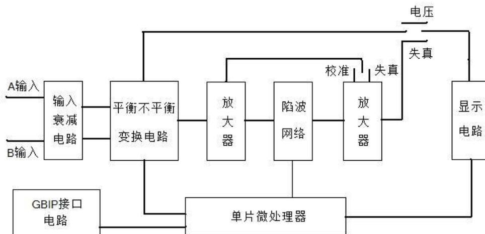
设计中对关键电路和器件采用了特殊的设计和制造工艺，并采用了当代计算机技术与之相结合，程控自动跟踪输入信号的频率、幅度，自动滤谐，全部数据由一块 LCD 显示屏集中显示。仪器面板上保留了示波器输出监视插孔，便于使用者直接观察被测信号的波形，特别在失真测量状态，使用者可直接观察到被测信号的失真主要是由哪次谐波形成的及滤谐状态，在小失真信号测量时，可以直接观察到整机的滤谐状态。
