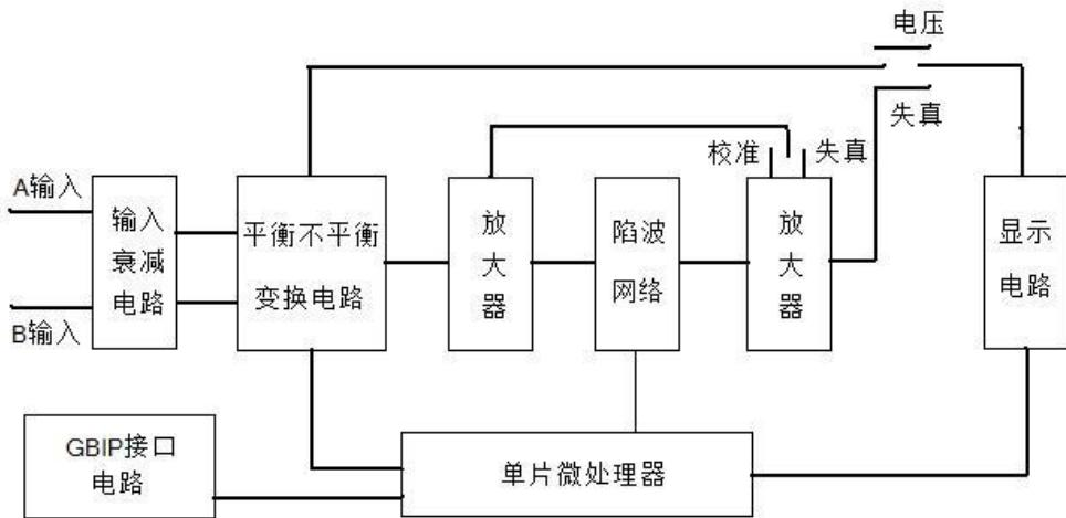
设计中对关键电路和器件采用了特殊的设计和制造工艺，并采用了当代计算机技术与之相结合，程控自动跟踪输入信号的频率、幅度，自动滤谐，全部数据由一块 LCD 显示屏集中显示。仪器面板上保留了示波器输出监视插孔，便于使用者直接观察被测信号的波形，特别在失真测量状态，使用者可直接观察到被测信号的失真主要是由哪次谐波形成的及滤谐状态，在小失真信号测量时，可以直接观察到整机的滤谐状态。
