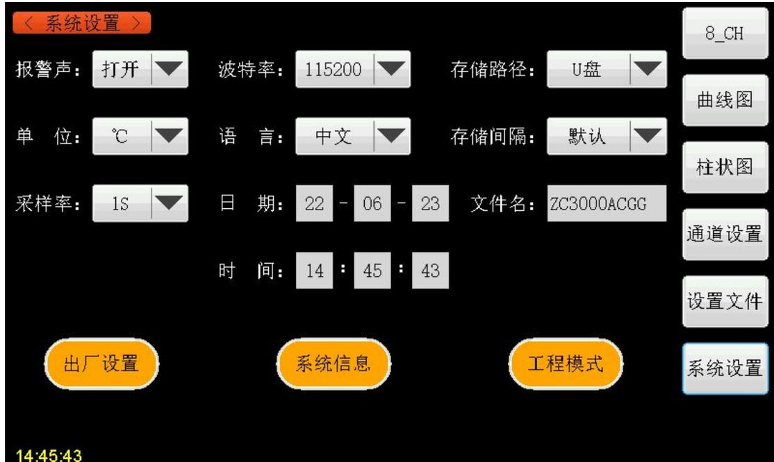
图 4.6.1 系统设置界面示意图
