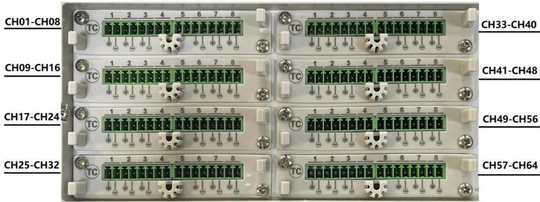
图 3.2.2 ZC3000-64 热电偶接口通道示意图
