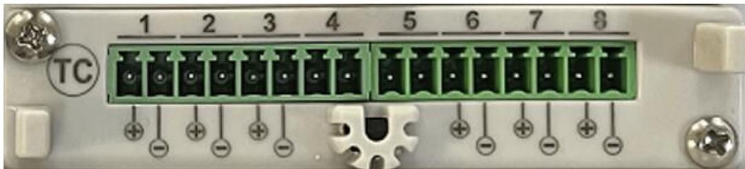
图 3.2.3 一组通道板热电偶接口示意图
