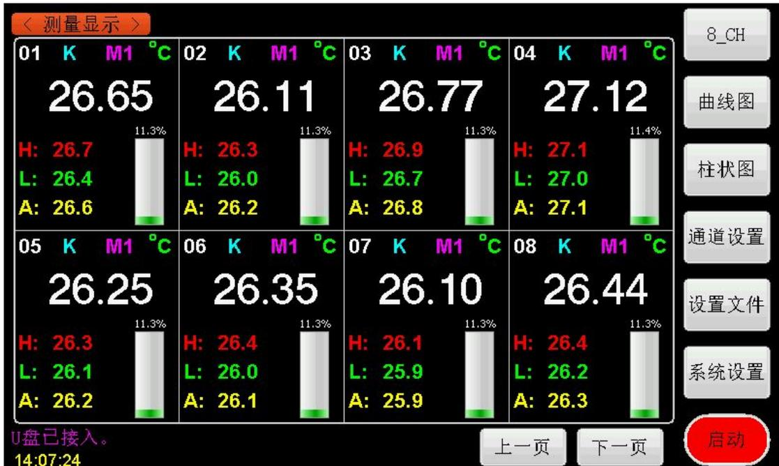
图 4.1.1 测量显示主界面（8\_CH 显示界面）
