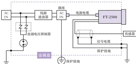
在设置FT-2500前, 请务必阅读以下注意点。如果设置方法存在问题, 会影响测量仪器的抗电磁噪声干扰的能力。
