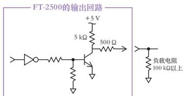
将算出的功率谱的频率转换成脉冲信号之后输出。因此, 如果将显示值设置为转速 (r/min) 时, 会导致显示值与脉冲输出的频率不一致。
