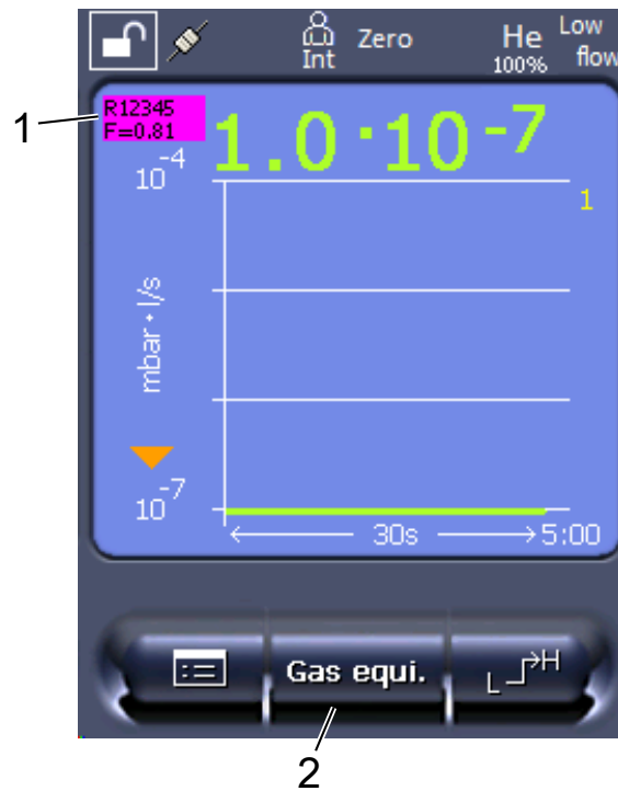
插图 23: 测量界面上显示等效漏率并设有收藏夹键
