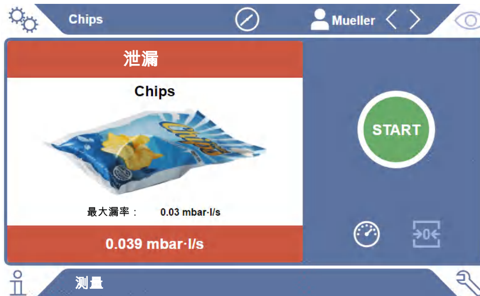
插图 4: 以红色背景显示的测量结果，对应于高漏率
