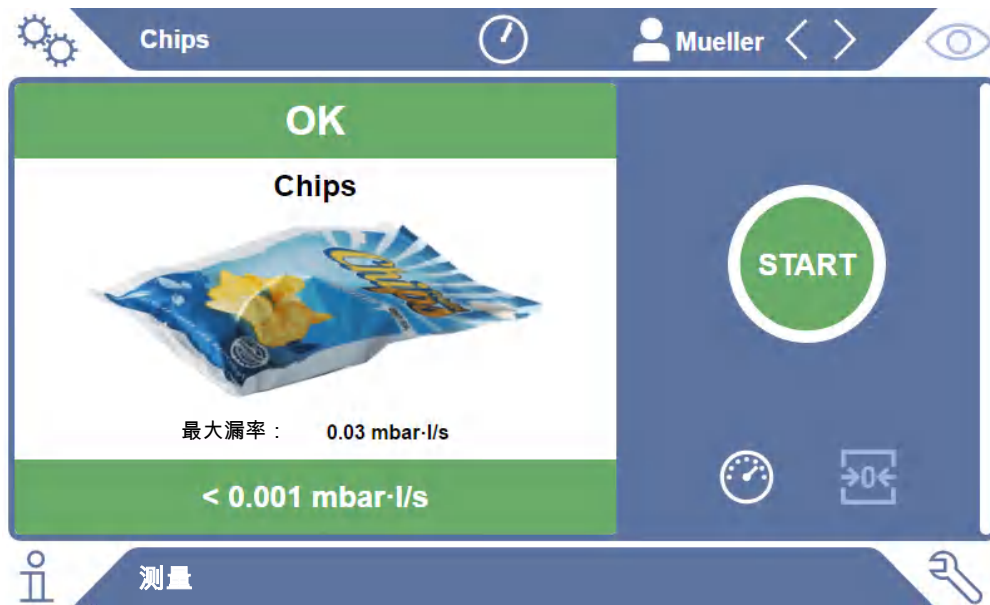
插图 3: 以绿色背景显示的测量结果，对应于无缺陷的测试对象
