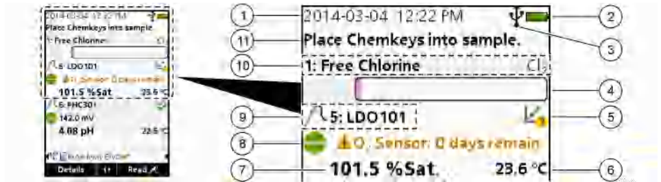
图 4 测量屏幕（顶部）
