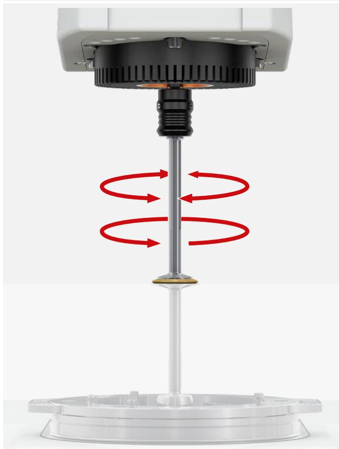
在该模式下,移除了线性马达,测量设备转变为传统的旋转流变仪。移除了线性马达的设备可以装配任何测量系统、控温系统和/或安东帕 MCR 系列流变仪现有的专用附件,以便对您的样品进行标准和复杂的流变分析。移除线性马达后,可在下面安装第二套旋转马达,以利用流变仪的所有测量模式进行高级流变测量。
