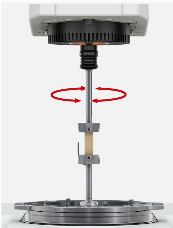
在该模式下,线性马达被置于一个固定位置,而旋转马达则用于控制剪切应变或剪切应力。与可用夹具联合使用时,如圆形和矩形固体夹具(SCF,SRF)、平行板或锥板夹具,该配置可为扭摆模式的动态机械分析和流变测量开创新的可能性。
