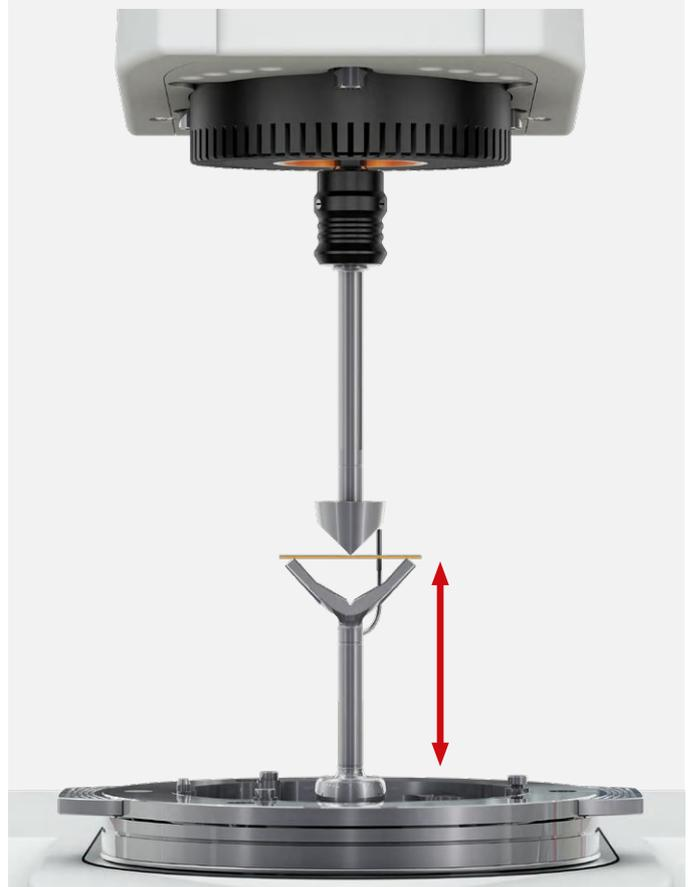
在该模式下, 旋转马达置于一个固定位置, 而线性马达则用于控制力或位移。配合测量夹具(如三点弯曲、单悬臂、双悬臂、拉伸、压缩模式下的 DMA 夹具)使用时, 该模式适用于进行精确的“经典”动态机械分析。此外, 您还可以在该模式下执行蠕变恢复测试、恒定应力或应变测量以及热机械分析。
