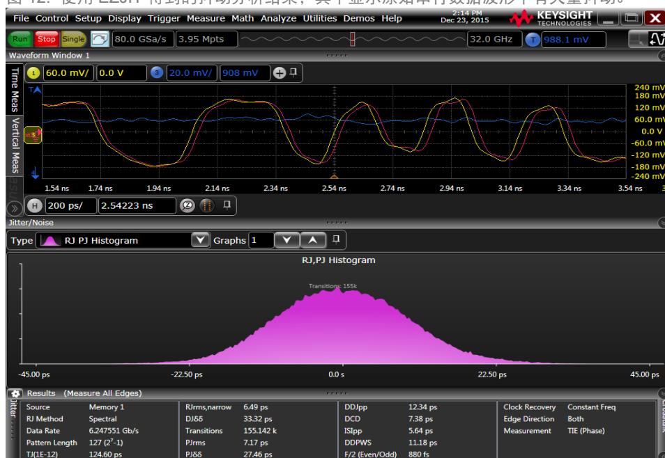
图 13. 使用 EZJIT 得到的抖动分析结果，其中显示消除电源干扰造成的抖动后，抖动统计数据有所改善。
