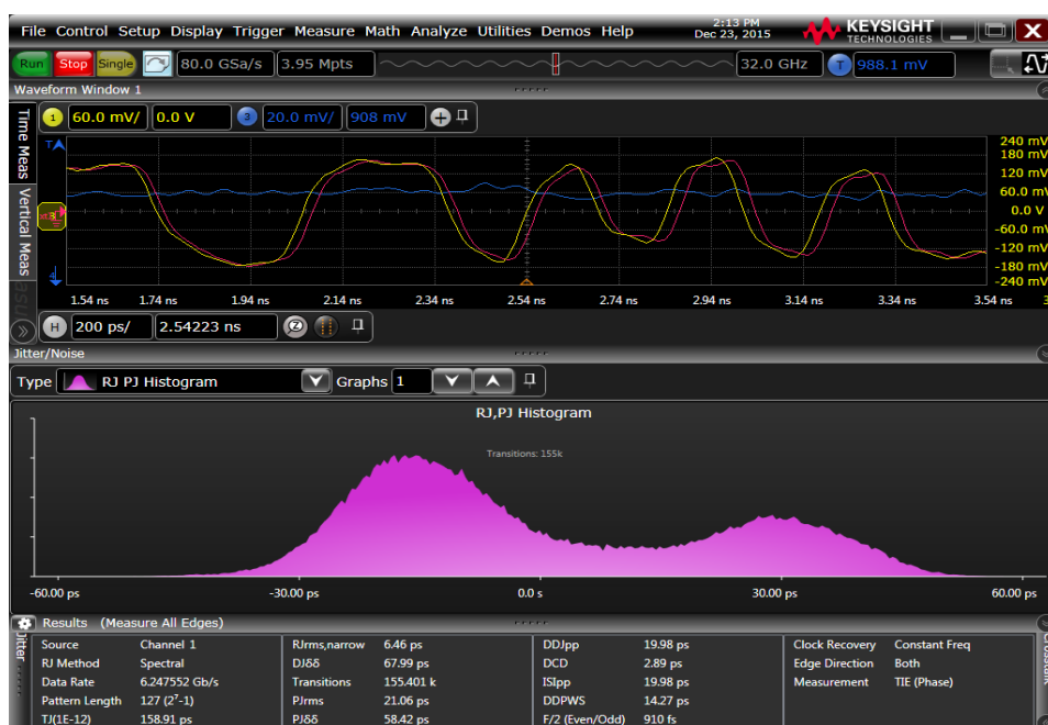
图 12. 使用 EZJIT 得到的抖动分析结果，其中显示原始串行数据波形中有大量抖动。
