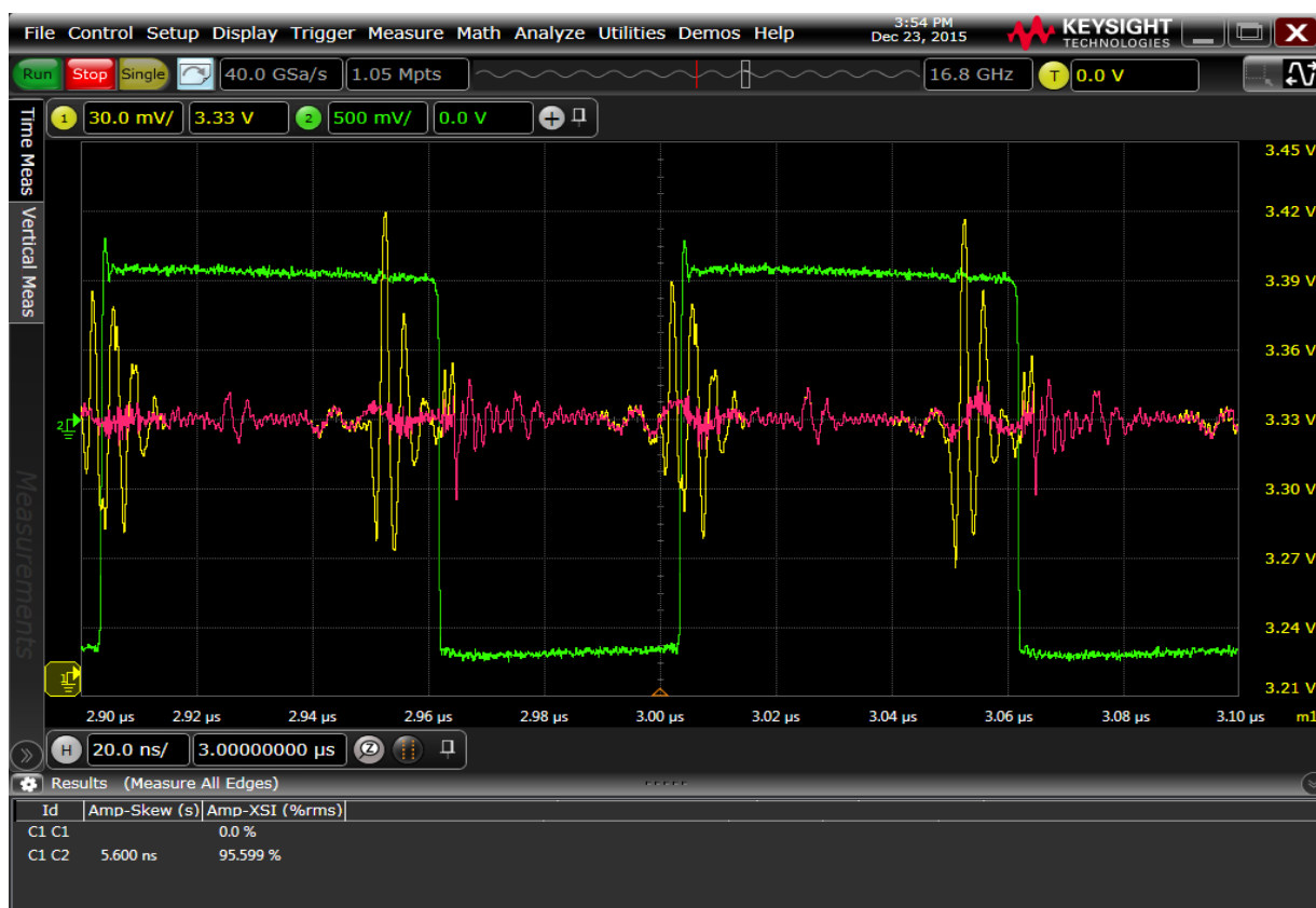
图 14. 电源作为受扰对象的示例。受扰波形（黄色）、干扰源（绿色）和消除了串扰后的波形（红色）。
