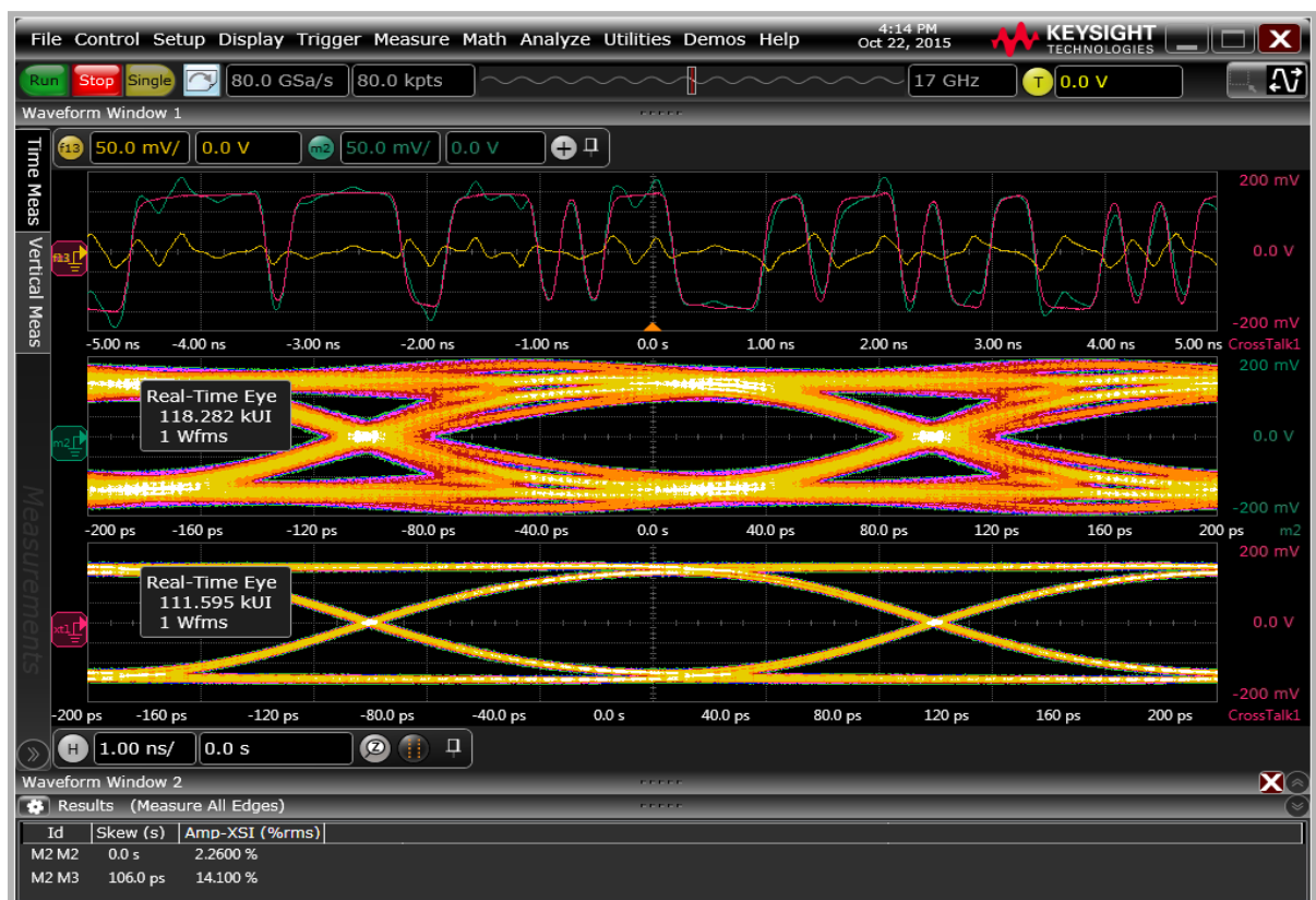
图 10. 含有远端串扰的受扰波形之前及之后的视图。上图显示了绿色的受扰波形、橙色的干扰波形和红色的消除了串扰后的波形。中图显示了受扰波形的眼图，其中的凸起表示远端串扰。下图为消除了串扰之后受扰波形的眼图。
