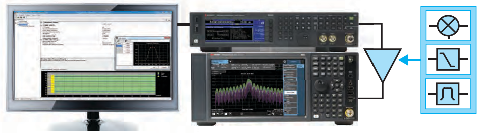
由 Signal Studio、X 系列信号发生器和分析仪构成的典型元器件测试配置。
