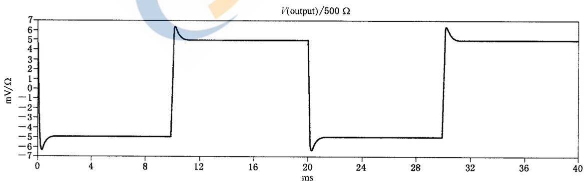
图 H.3 1 ms 脉冲响应,惊吓反应
