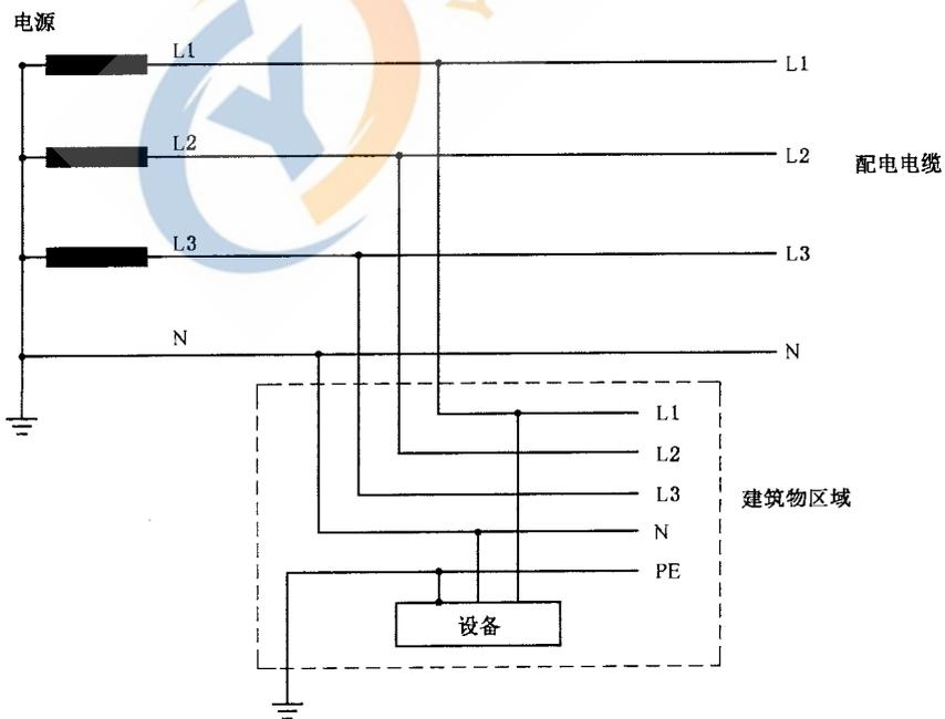
接地的中线和设备上独立的接地线
