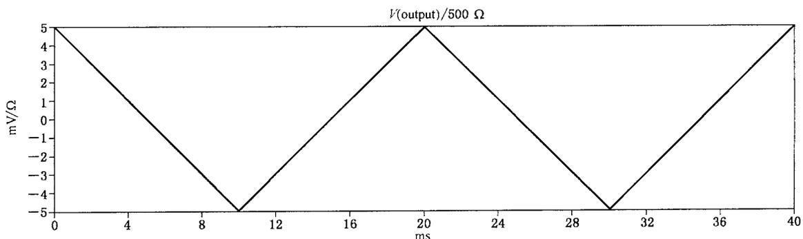
图 H.1 三角波形接触电流,惊吓反应
