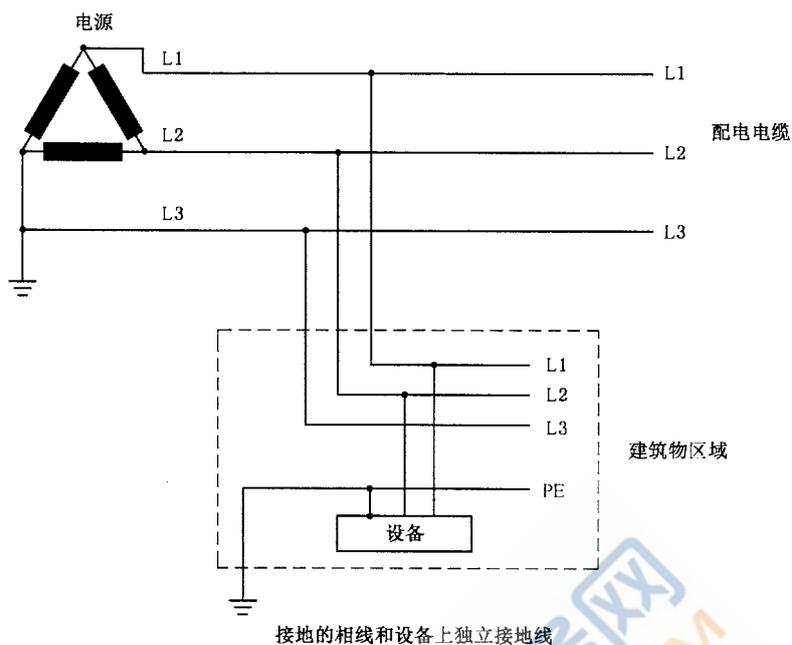
图 I.6 三相线的 TT 配电系统
