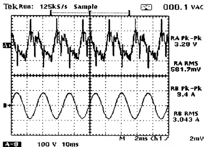
图 H.6 PFC 开关电源接触电流波形
