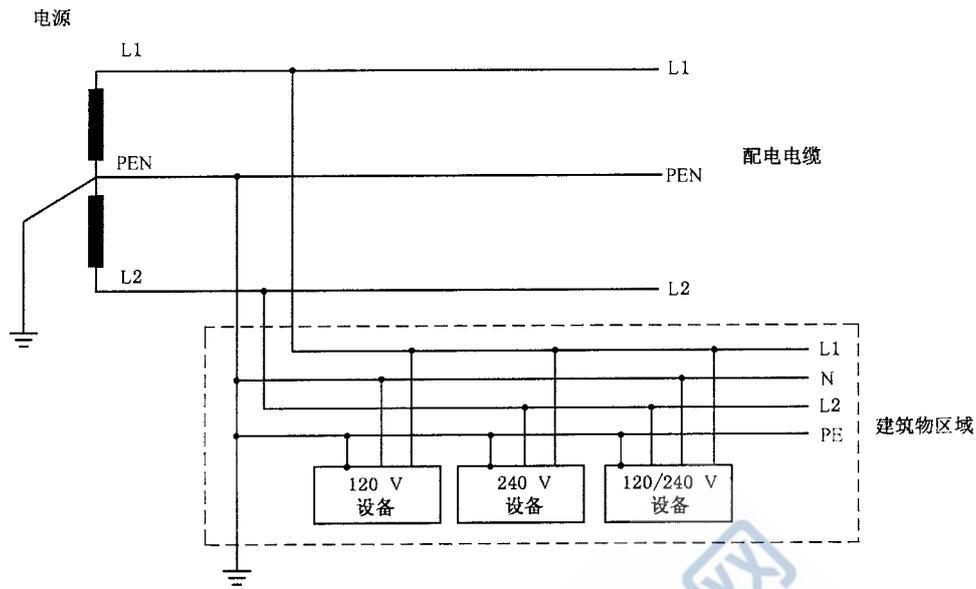
中线和保护接地功能合并在一根单独的导线上(PEN)
