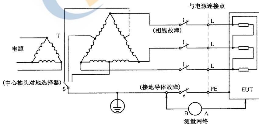
注：如果设备包含有三相负载和中心接地单相负载，而且接地的绕组(侧)已经确定，则开关 g 宜停留在已确定的接地侧的位置上。
