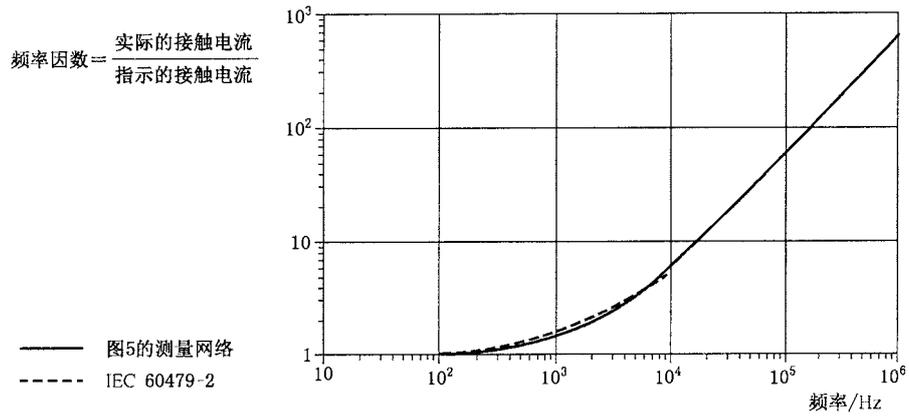
图 F.3 摆脱制动电流的频率因数
