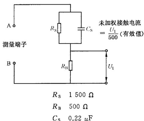
图 3 未加权的接触电流的测量网络
