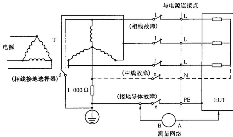
注：对配电系统的故障，宜规定 1 kΩ 的电阻器。
