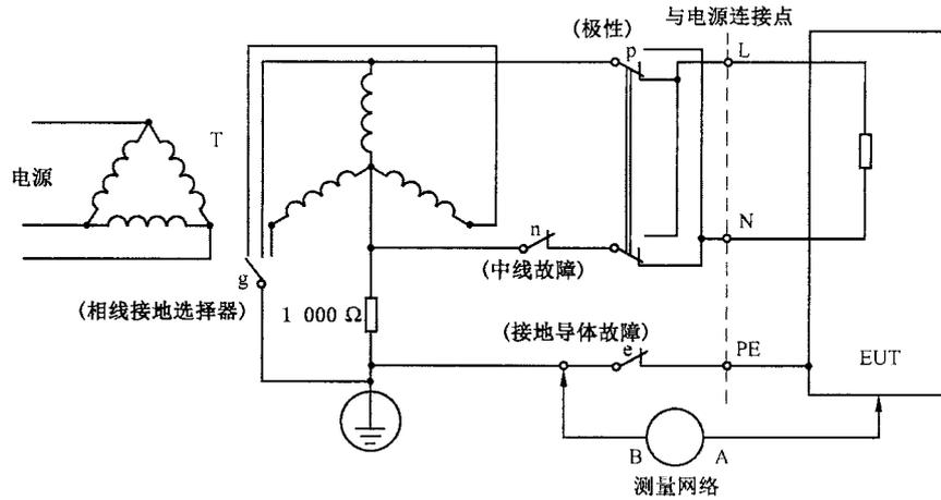
注：对配电系统的故障，宜规定 1 kΩ 的电阻器。
