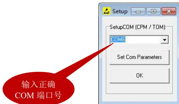
如果没有显示正确的 COM 端口，手动输入设备属性所指示的 COM 端口。选择完端口后，点击“OK”确认，返回主界面。
