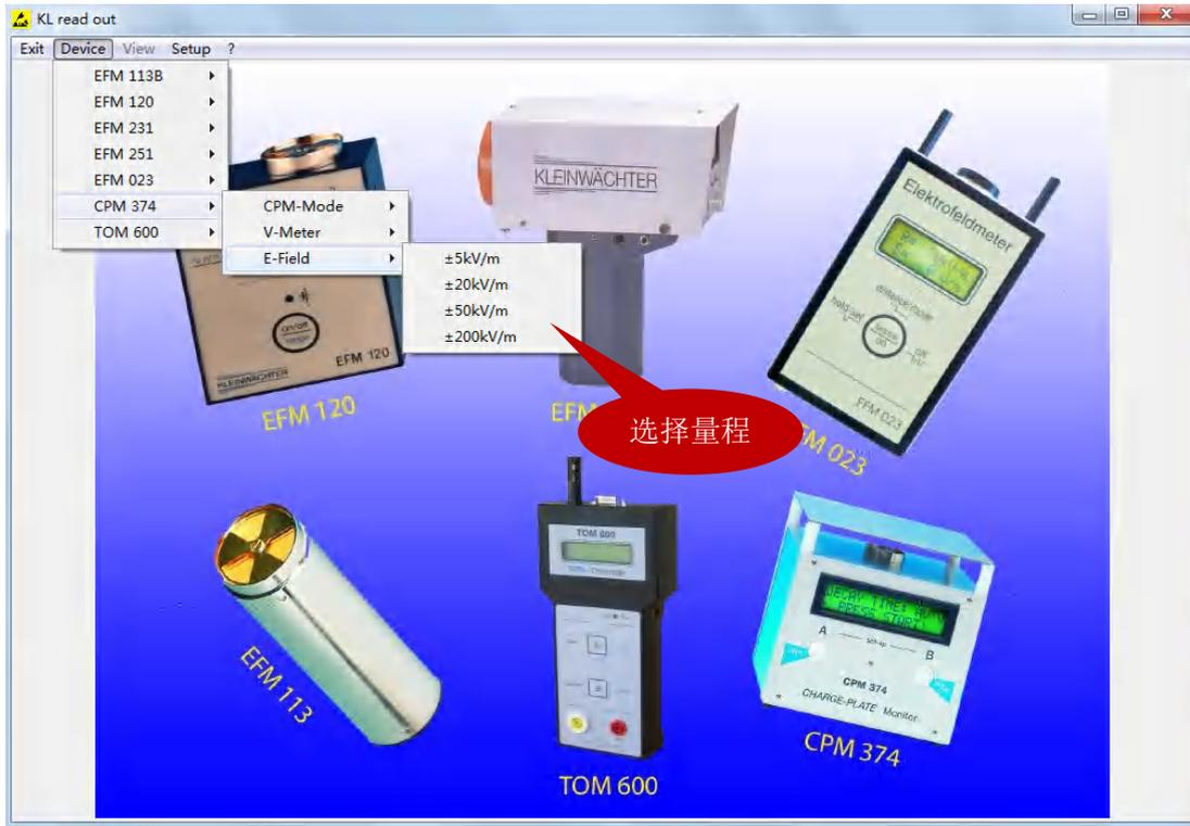
在 E-Field 模式下,有 4 档量程,软件界面需根据 CPM-374 仪器上所设置的量程来相应选择。
