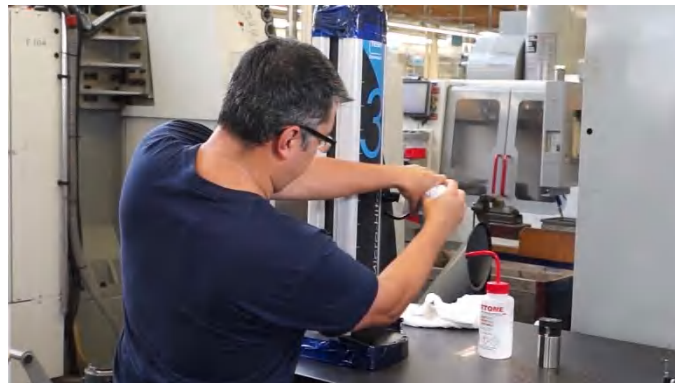
16 小心的从基座、把手和仪器顶盖上去除防护胶带.
