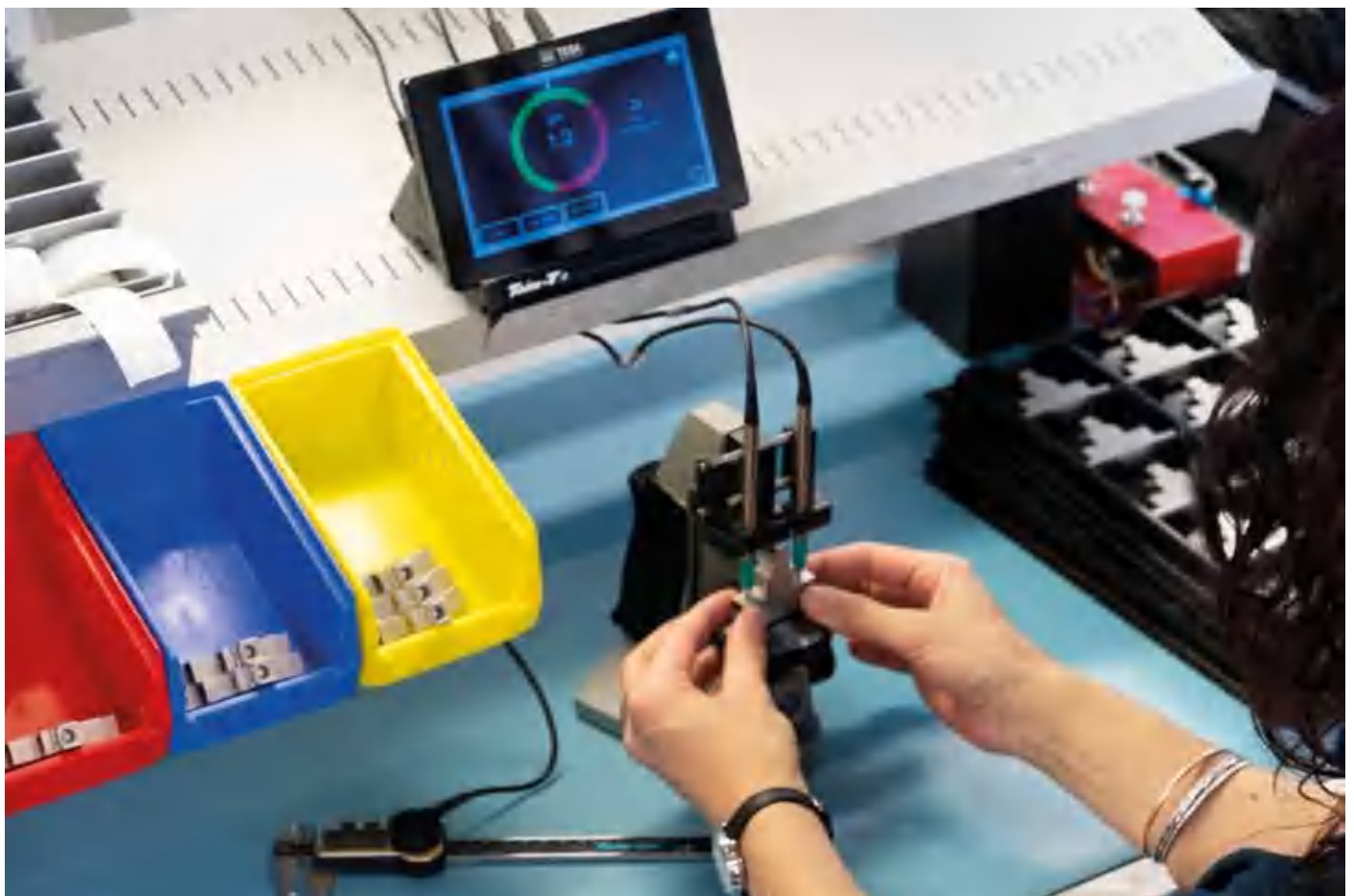
零件分类：操作人员根据屏幕轮廓线的颜色将零件放入同色容器
