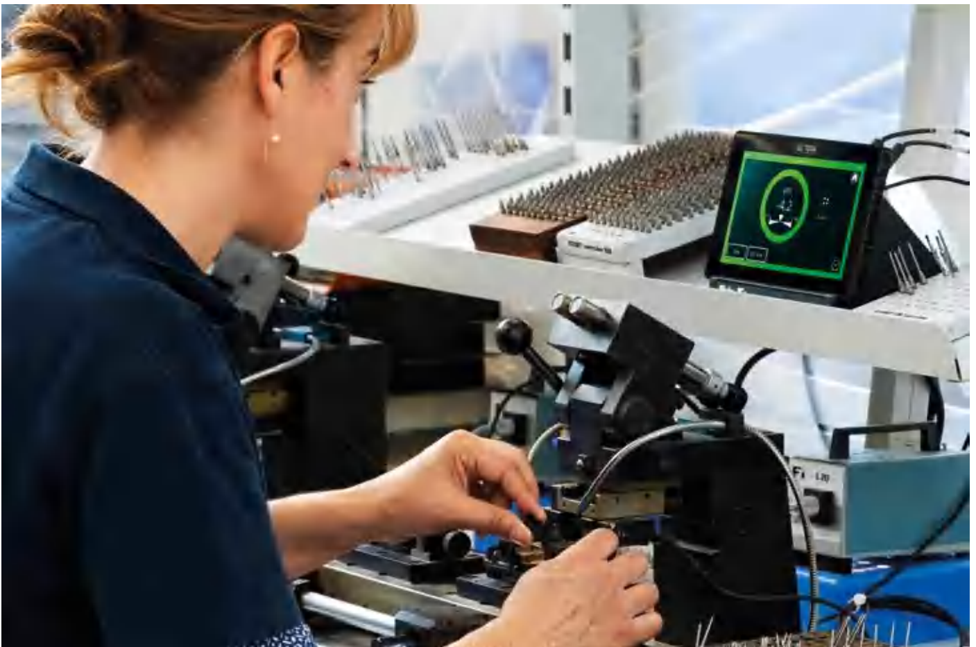
圆柱形零件装配前的同心度测量
