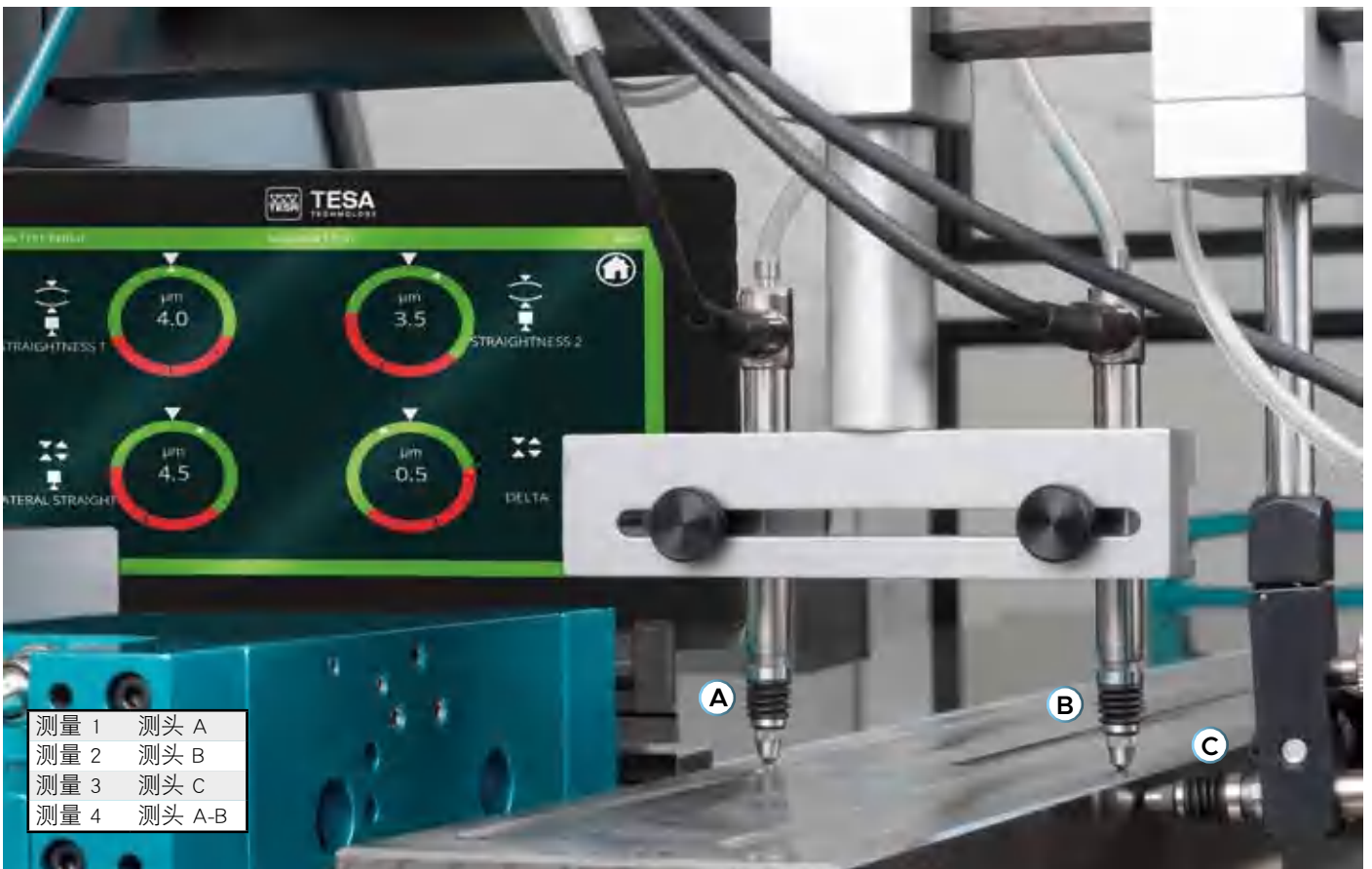
同时测量两轴的平直度
