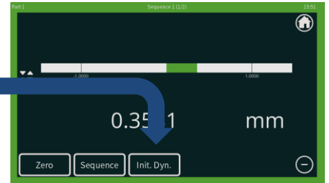
测量界面上的 Init.Dyn. “动态初始化” 键用于使数值 (最小值、最大值等) 初始化 (若选定动态运行模式)。
