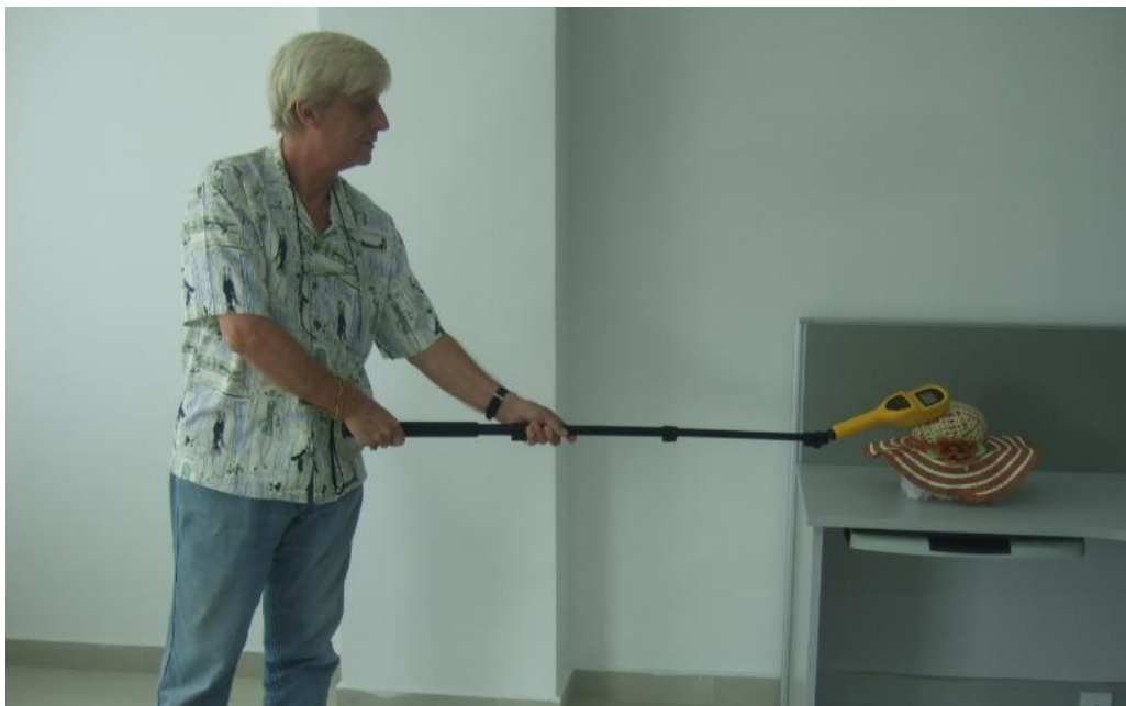
伸缩杆，最长 1.6 米，可远距离测量核射线，避免人体受到伤害
