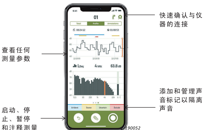
图2 直接通过手机控制、查看和注释测量
