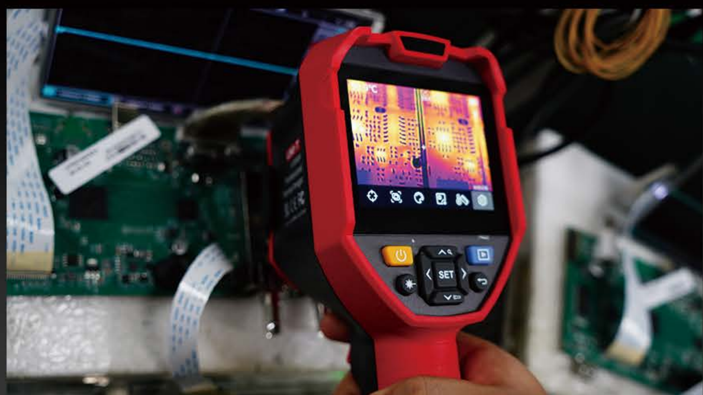
电路板温度筛查检测
